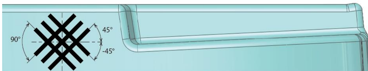
Obr. 24 Orientace vláken tkaniny v žebrování na konci
