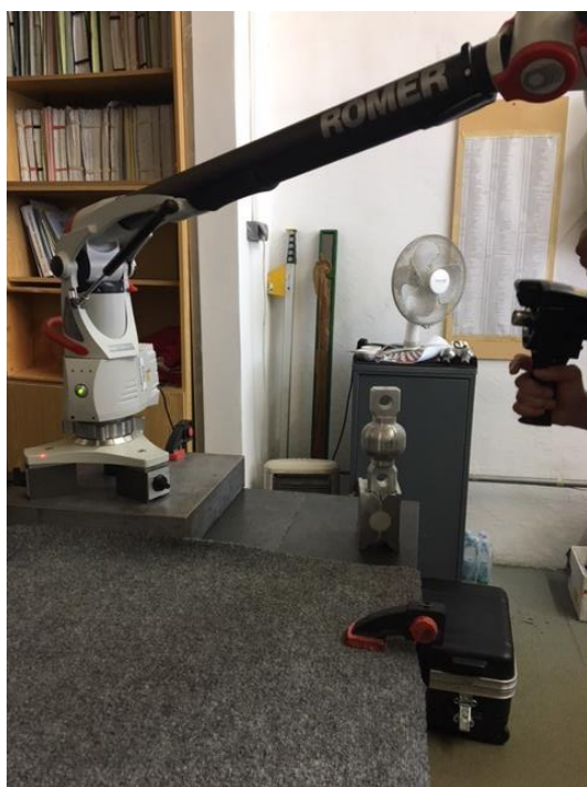
Obrázek 22 Měření měřicím ramenem
