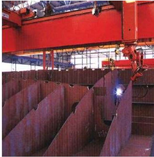
Obr. 3.6.10 - Svařovací robot umístěný na transportním modulu a dvěma stabilními polohovacími manipulátory [14]
