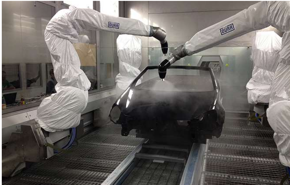
Obr. 3.1.3 - Linka pro lakování karoserie [6]
