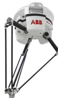
Obr. 3.3.3 - Robot s paralelní kinematickou strukturou [7]
