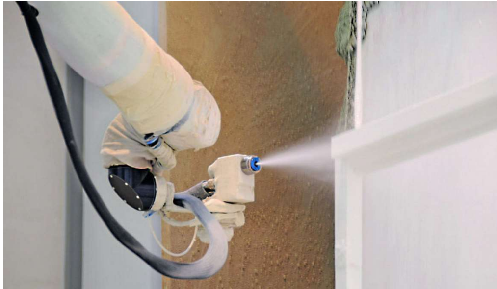
Obr. 3.4.3 - Pracovní hlavice pro lakování [10]
