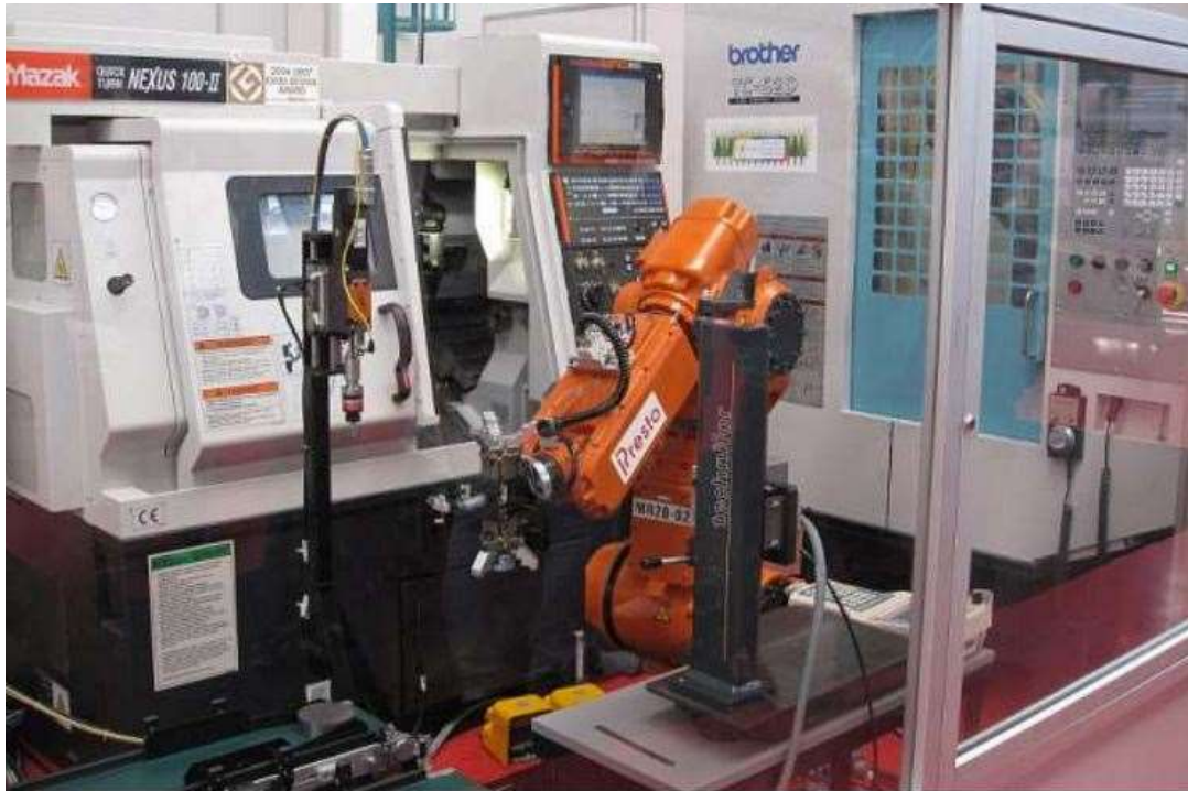
Obr. 3.1.1 - Robot pro manipulaci s obrobkem [4]
