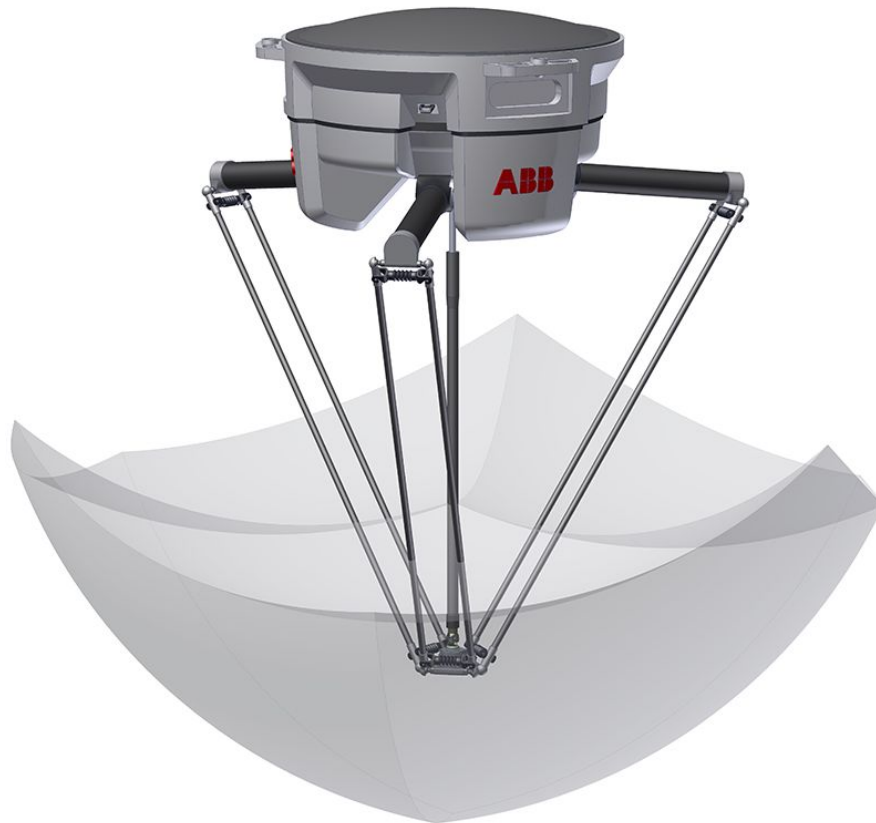
Obrázek 2.5: Pracovní plocha paralelního robota - převzato z www.mecademic.com
