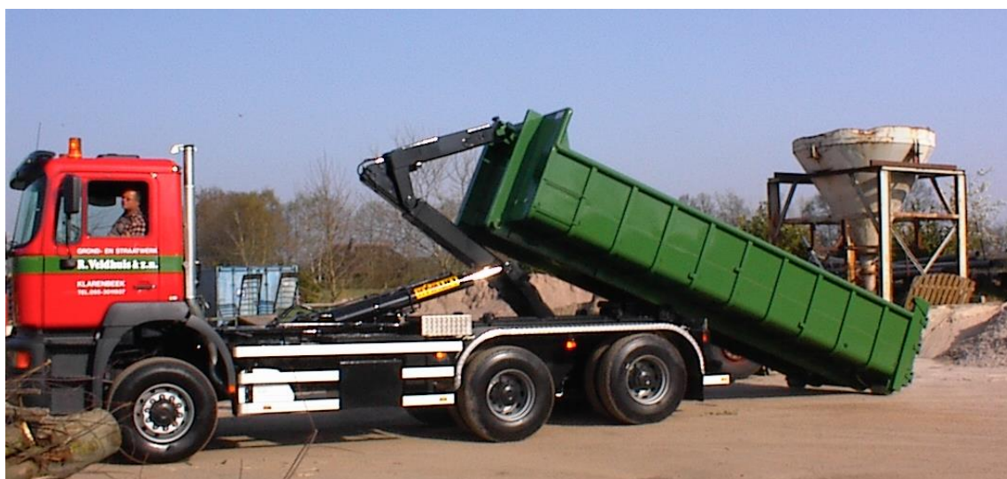
Obr.3.: Hydraulický sklápěcí mechanismus
