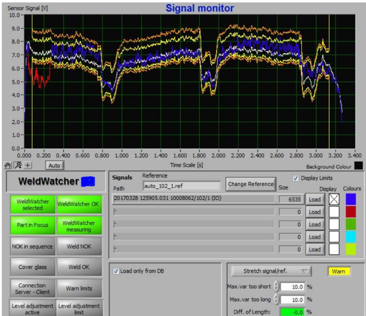
Příloha 10: vzorek 27, svar 23, Weld watcher
