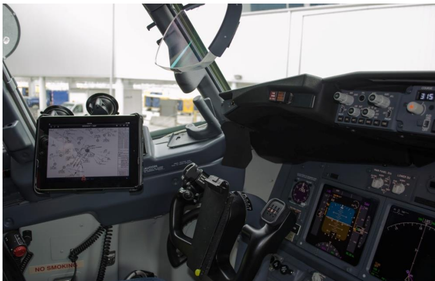
Obrázek 2. Přenosný typ zařízení EFB instalovaný v certifikované platformě [45]
