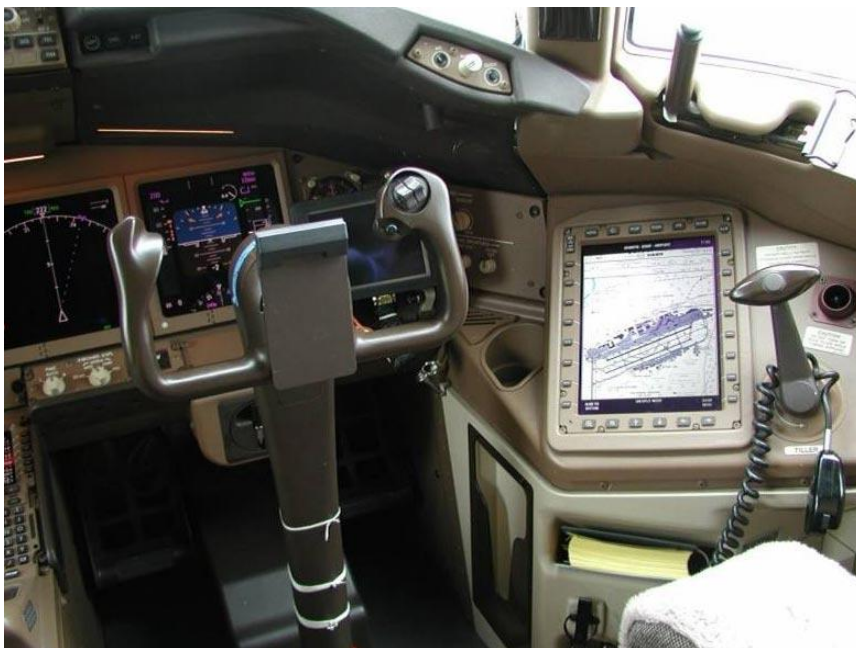
Obrázek 3. Instalovaný typ EFB, zástavba letounu B777 [46]
