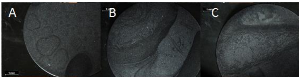
Obr. 30. Detail nečistot na povrchu vzorku, který byl tryskán
