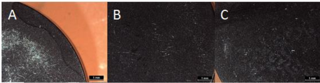
Obr. 29. Detail nečistot na povrchu, kde byl pouze původní povrch Medinu
