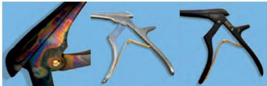
Obr. 18. Barevné změny na štípacích kleštích s povlakem z TiAlN. Duhově zbarvené štípací kleště. Štípací kleště nové. [20]
