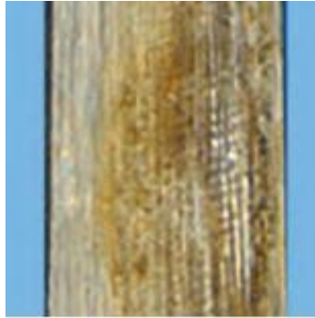
Obr. 14. Třecí koroze na kostních nůžkách [20]
