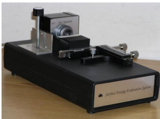
Obr. 20. SeeSystem Stolek s CCD kamerou a posuvem [24]
