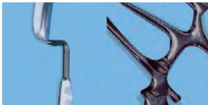
Obr. 17. Oxidace háku na rány a svorky [20]
