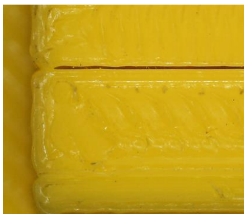
Obr. č.61 Žebro 0,2 mm se spečeným koncem
