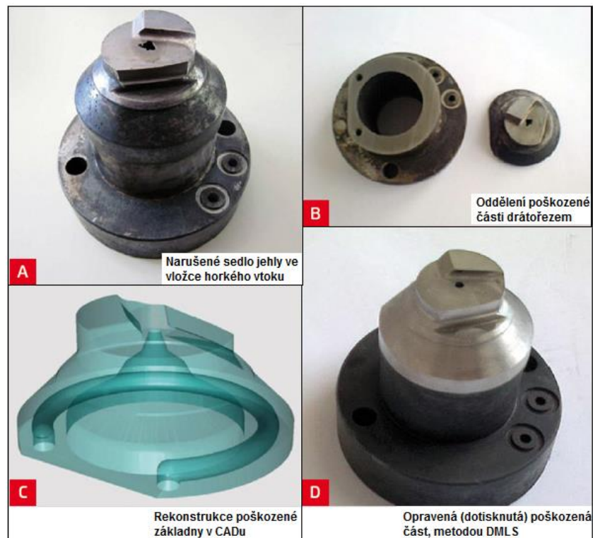
Obr. č.16 DMLS oprava části formy [31]
