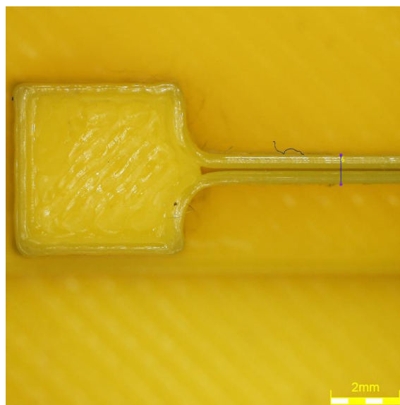
Obr. č.59 Žebro 0,8 mms dutinou uprostřed
