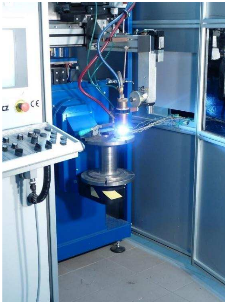
Obrázek 13: Navařování na automatickém plazovém zařízení PPC 250 R6 (KSK,s.r.o., Česká Třebová)
