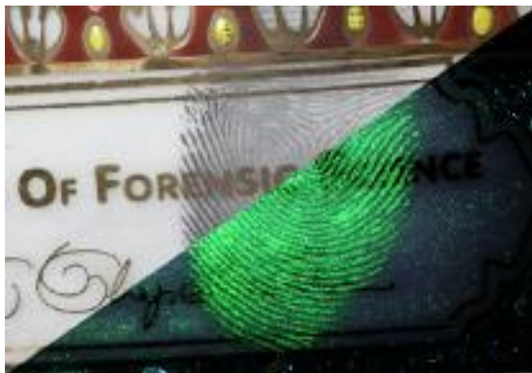
Obrázek 10: Fluorescence duálního „purpose“ černého prášku při UV osvětlení [10]
