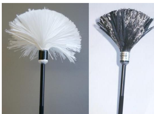
Obrázek 13: Moderní daktyloskopické štětce [9] (vlevo skleněné vlákno, vpravo uhlíkové vlákno)
