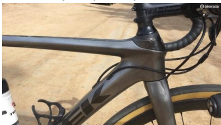
Obrázek 23: Krátká hlavová trubka ( http://cdn.mos.bikeradar.imdserve.com/images/news/2017/03/26/trek-domane-slr-race-shop-limited-disc---2-1490560429832-1lt6dfmg2agg-630-354.jpg )
