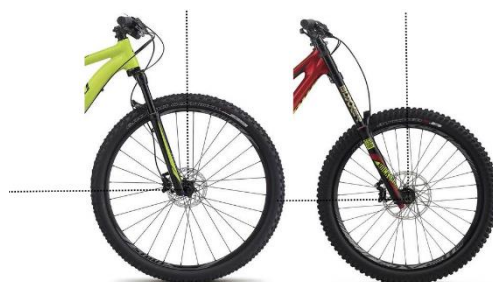
Obrázek 18: Úhel 71° (VLEVO) a 63,5°
