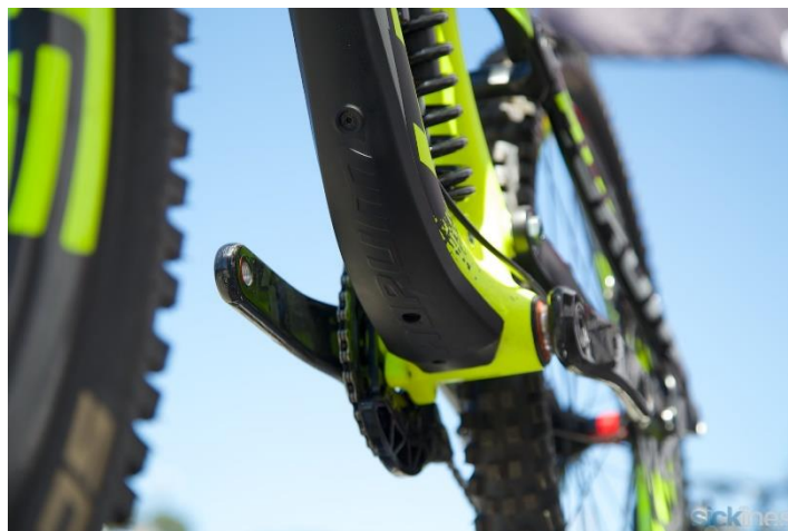
Obrázek 47: Zploštělá dolní trubka ( http://www.sicklines.com/wp-content/uploads/2015/04/Norco-Aurum-C71-enve-bottom-bracket-guard.jpg )
