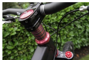
Obrázek 22: Podložky pod představcem ( https://www.mtb-mag.com/wp-content/uploads/2015/03/03.jpg )
