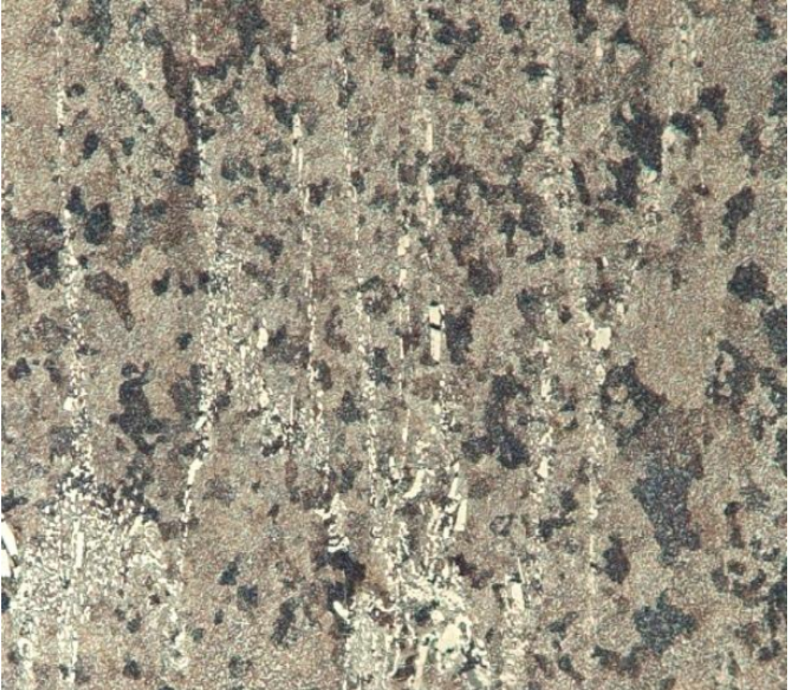
Obr. 13. Karbidy v oceli ČSN 19 830 (8)
