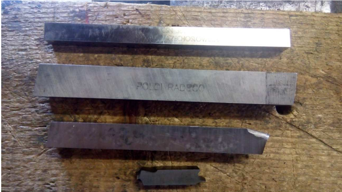
Obr. 12. Ukázka RADECO od firmy POLDI- dva spodní nože jsou dílensky vybroušeny do požadovaného tvaru
