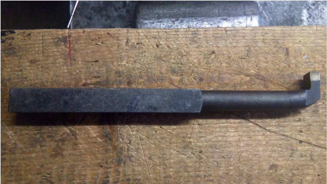
Obr. 26. Ukázka Kovaného vnitřního soustružnického nože z HSS
