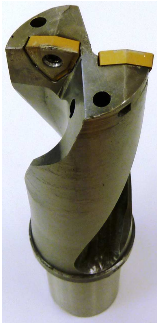
Obr. 34. Vrták s VBD a vnitřními chladicími kanálky (20)
