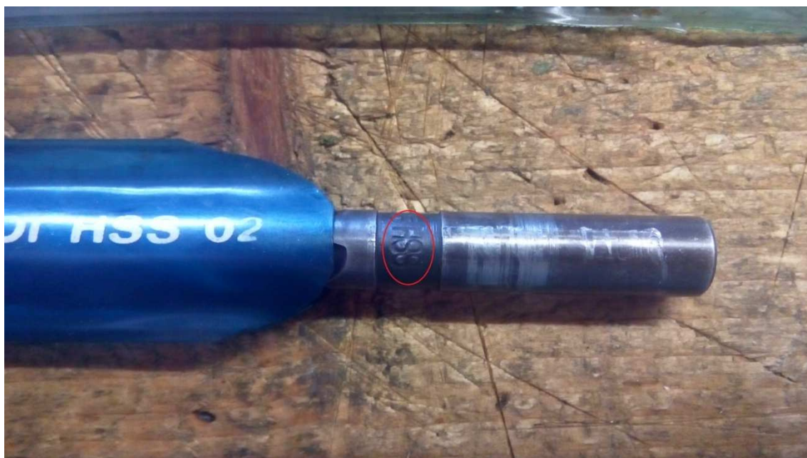
Obr. 10. Detailní foto ražení HSS na vrtáku
