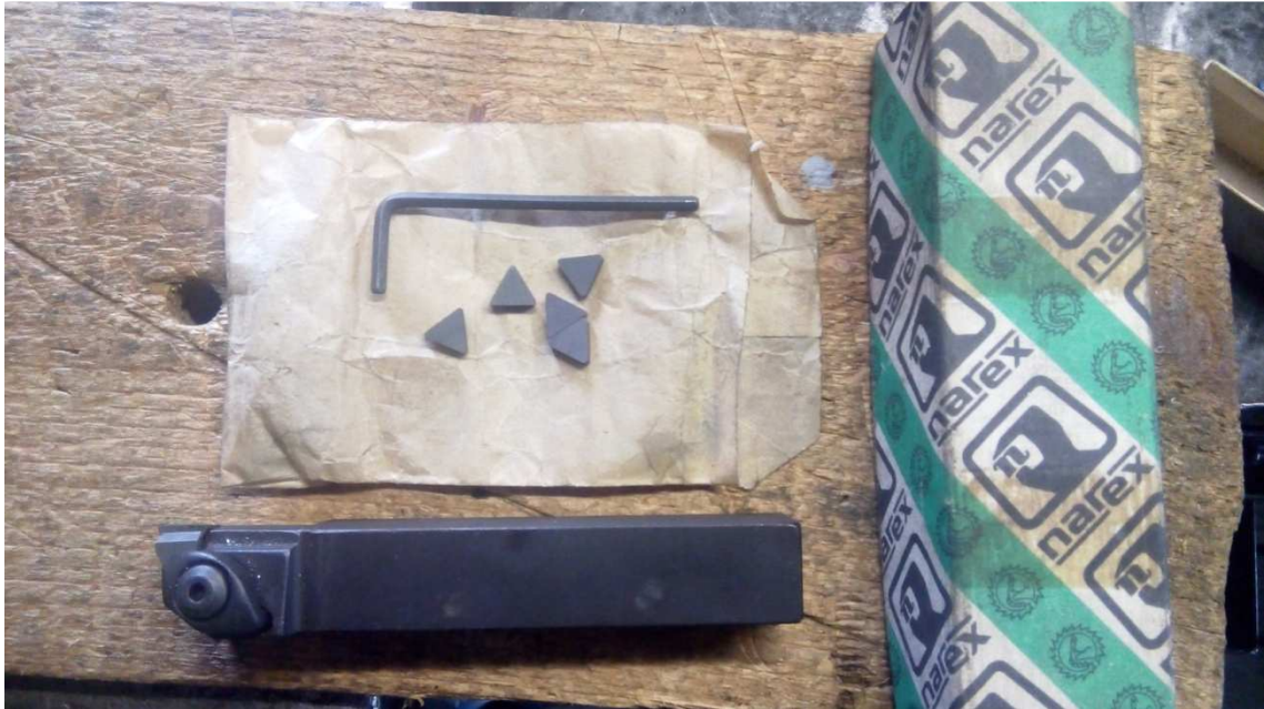
Obr. 28. Ukázka staršího soustružnického nože s vyměnitelnými vícebřítými destičkami firmy NAREX v původním balení
