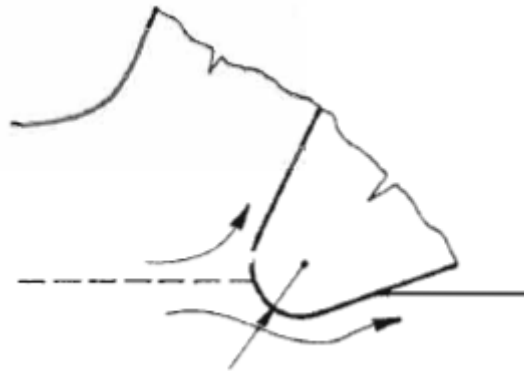
Obr. 6. Tečení materiálu u ostří nože (1)
