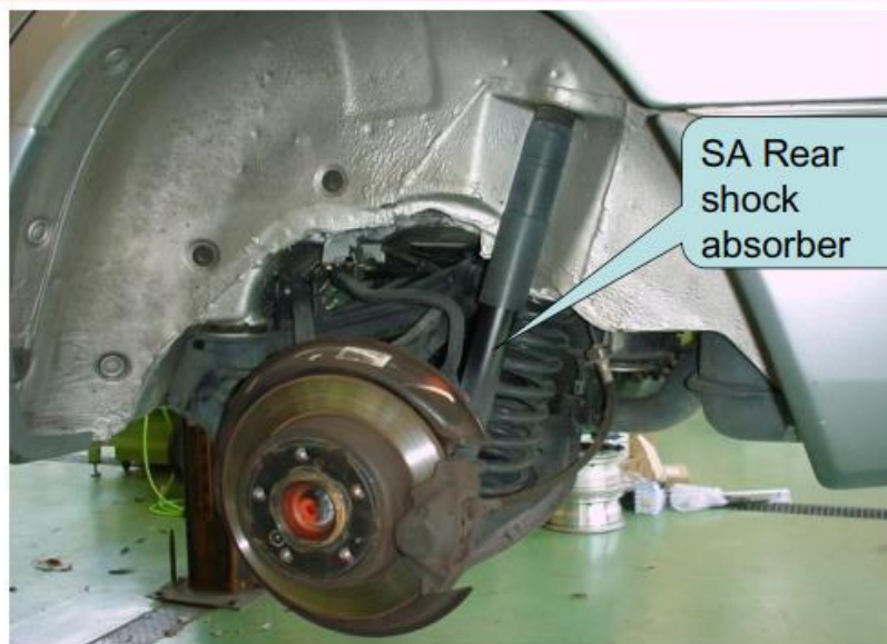
Obr. 45.: Umístění zadního tlumiče v automobilu [20]
