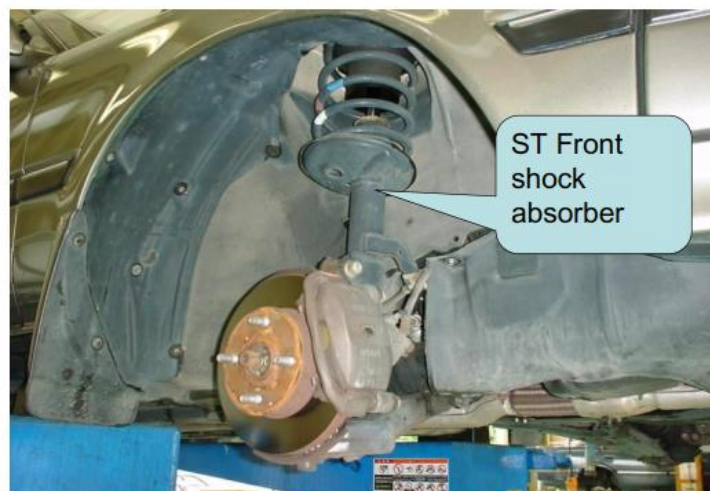
Obr. 51.: Umístění předního tlumiče v automobilu [20]
