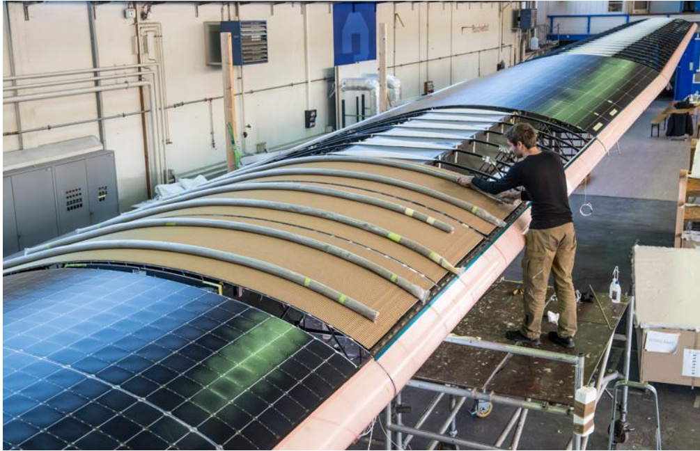
Obrázek 4 Detail konstrukce křídla Solar Impulse
