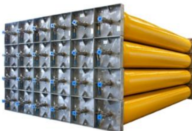
Obrázek 18 - Vnitřní část kontejneru
