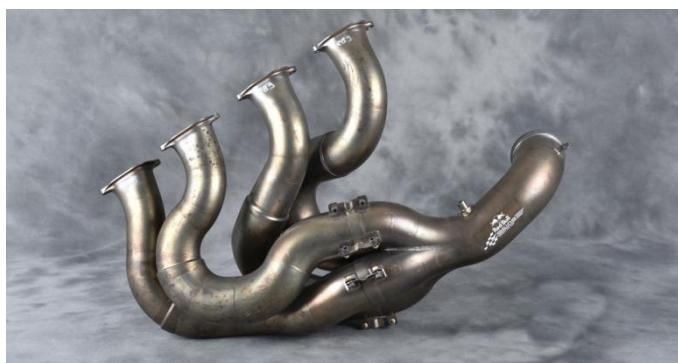
Obrázek 3.1 - Výfukové svody s uspořádáním 4-1
