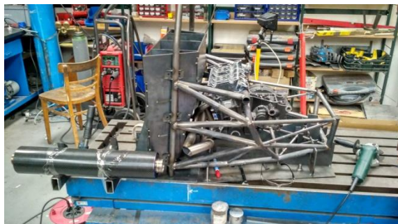
Obrázek 10.9 - Sestava pro svařování výfukového potrubí
