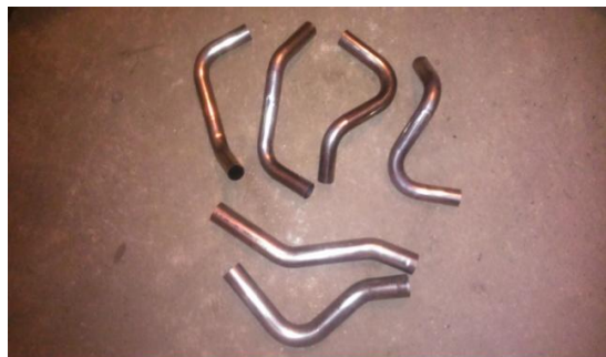
Obrázek 10.10 - Naohýbané výfukové potrubí
