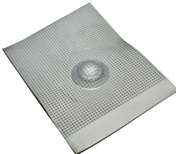
Obr. 26 Ukázkový zkušební vzorek po zkoušce dle Erichsena
