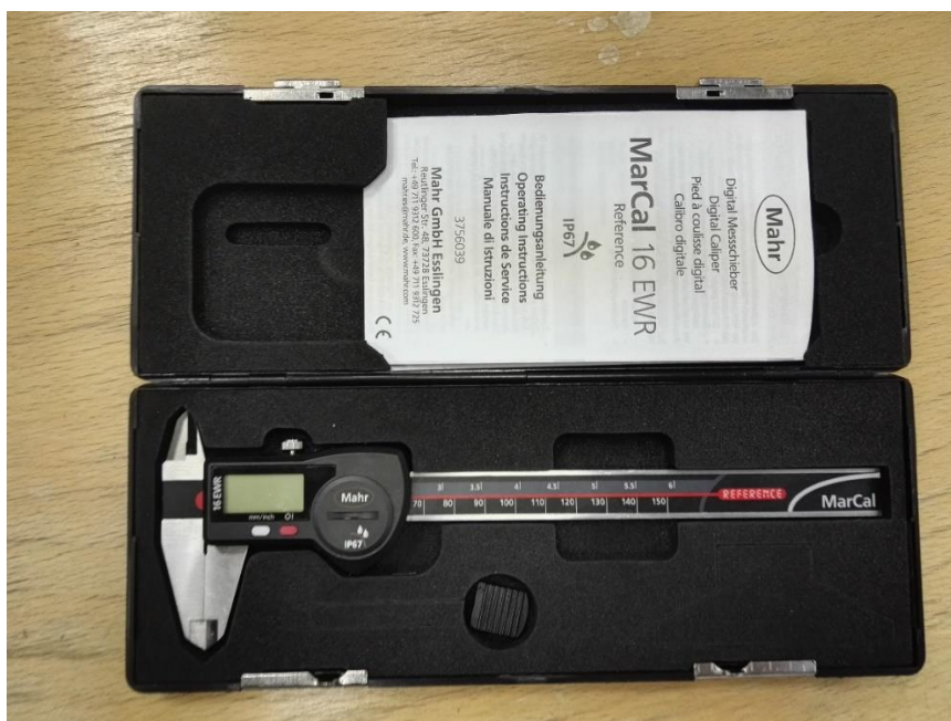
Obrázek 11: Digitální posuvné měřítko Mahr Marcal 16 EWR
