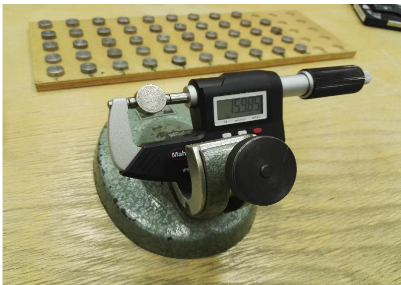
Obrázek 16: Měření na digitálním mikrometru
