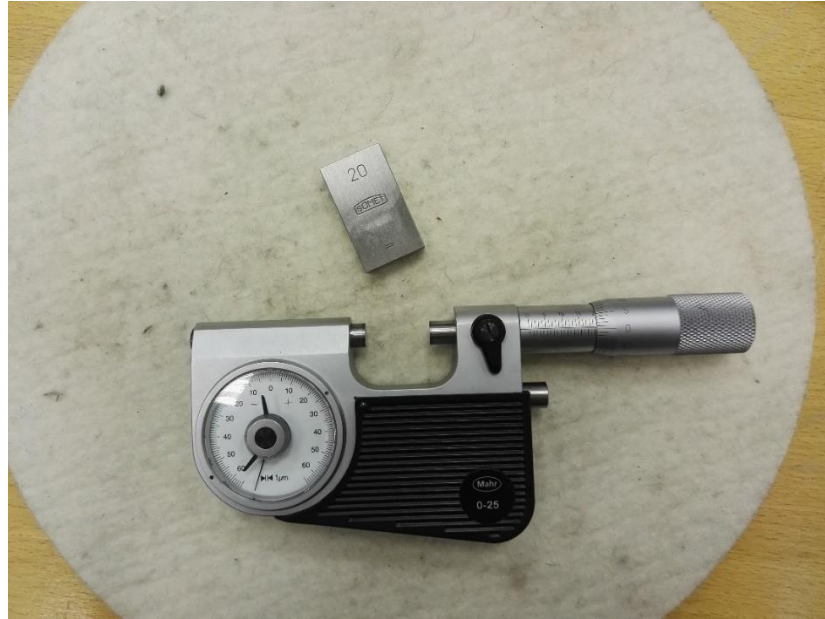
Obrázek 13: Passametr Mahr Micromar 40F/40T/40TS
