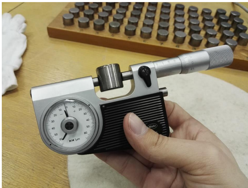
Obrázek 17: Měření na passametru
