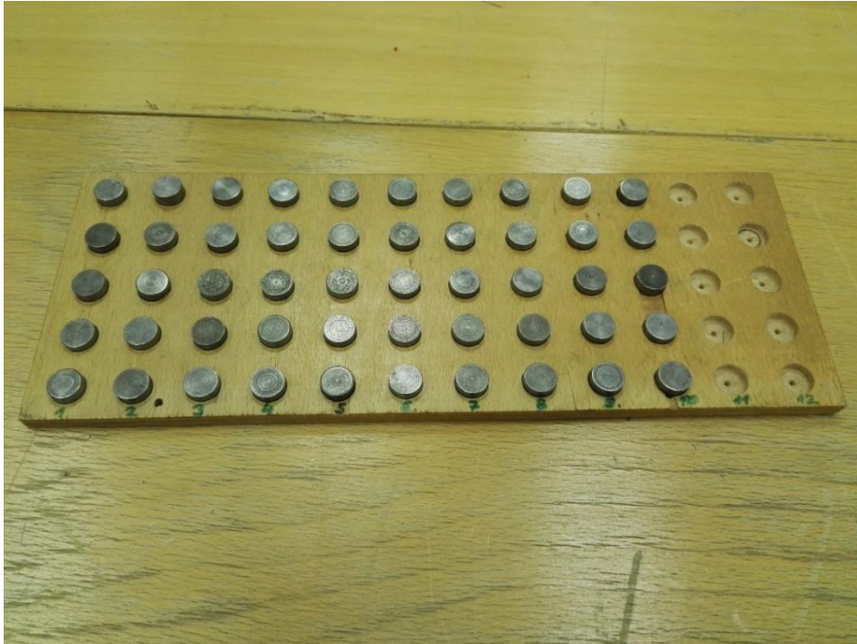
Obrázek 9: Válečky broušené na bezhroté brusce
