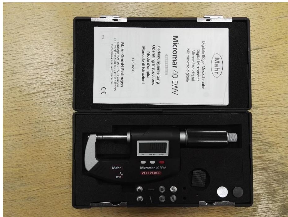
Obrázek 12: Digitální třmenový mikrometr Mahr Micromar 40 EW
