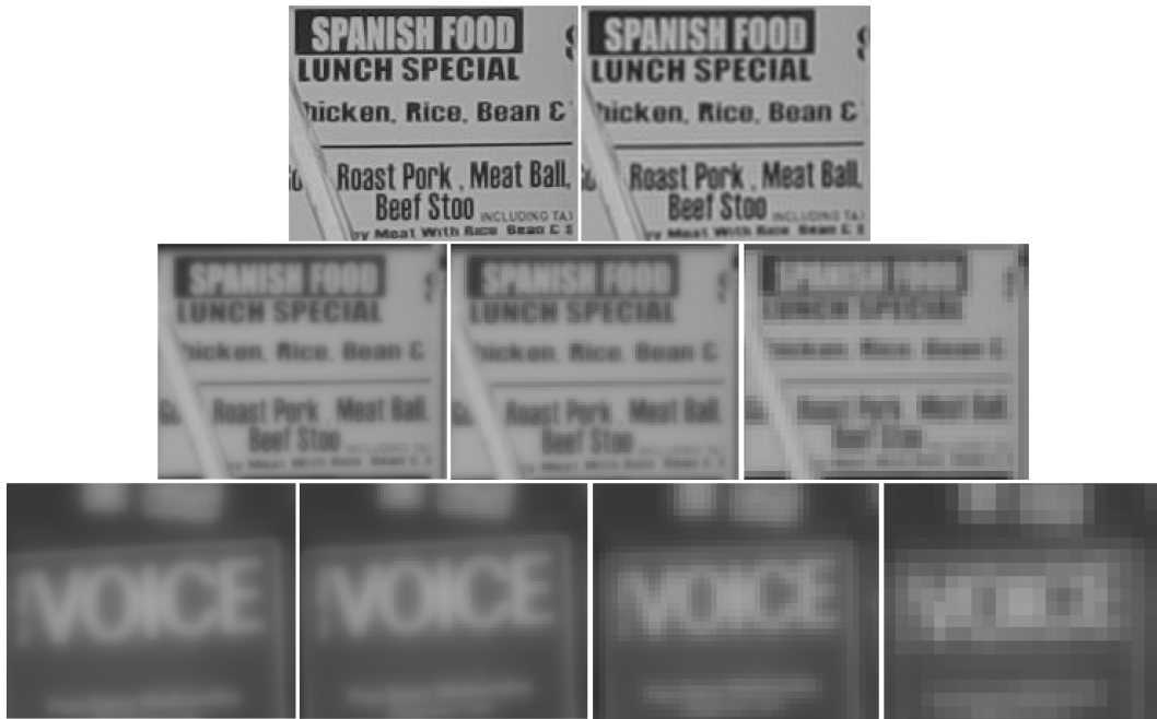
Obrázek 4.5: Ukázka různého zkreslení detailů snímku Street. První řádek: bez umělého zkreslení, originální a poloviční rozlišení, kdy na polovičním rozlišení již nelze rozeznat text Meat With Rice . Druhý řádek: zkreslení s f_{50} = 25 \text{ lp/mm} , v originálním i polovičním rozlišení lze narozdíl od čtvrtinového rozlišení přečíst nápis Chicken, Rice, Bean C . Třetí řádek: zkreslení s f_{50} = 8 \text{ lp/mm} , zatímco na originálním, polovičním i čtvrtinovém rozlišení lze ještě rozeznat poměrně velký nápis VOICE , na další úrovni sníženého rozlišení již ne.
