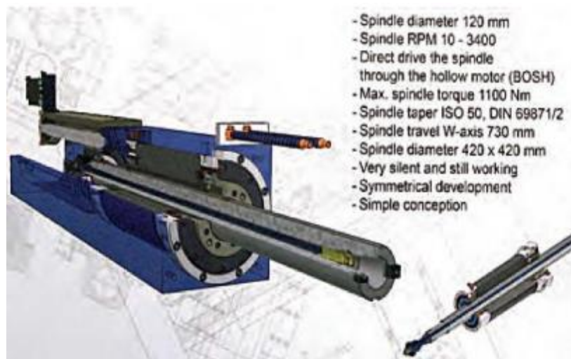
Obr. 34: Elektrovřetenno horizontky Fermat [10]
