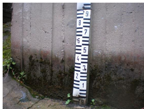
5 – hladinoměr pro měření hladiny řeky [18]
