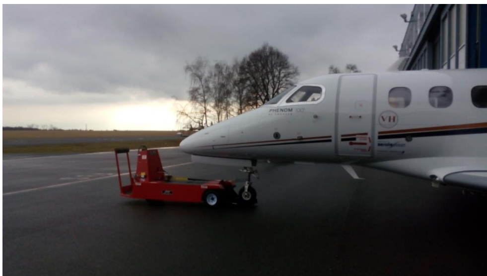
Obr. 16: Manipulace s letadlem pomocí tahače Lektro AP8360
