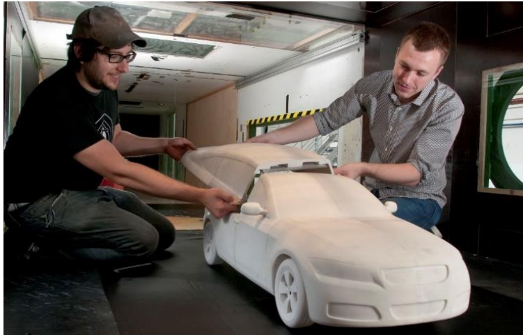
Obrázek 2: Sestavování modelu DrivAer v aerodynamickém tunelu [12]
