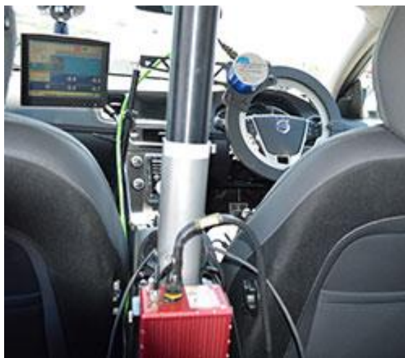
Obrázek 16: Umístění stabilizované plošiny RT3000 ve vozidle – „červená krabička“ [37]
