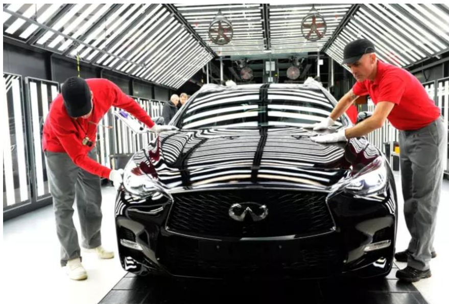
Obrázek 6: Kontrola povrchu karoserie [40]
