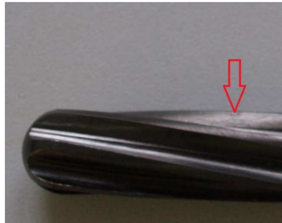
Obr. 87 Fréza č. 4 detail koroze šipka značí místo defektu
