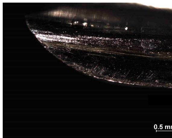
Obr. 13 Celkový pohled na opotřebení ostří
