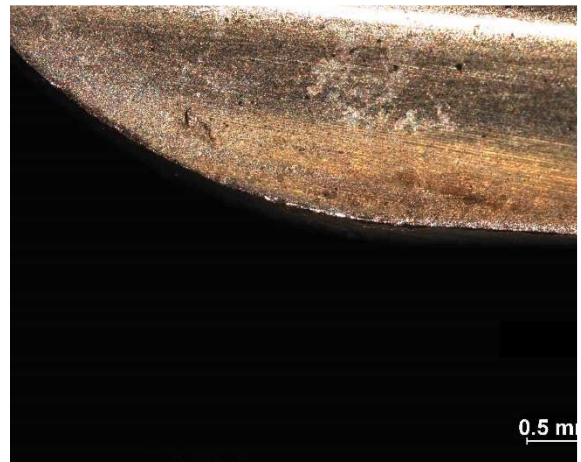
Obr. 29 Celkový pohled na opotřebení ostří
