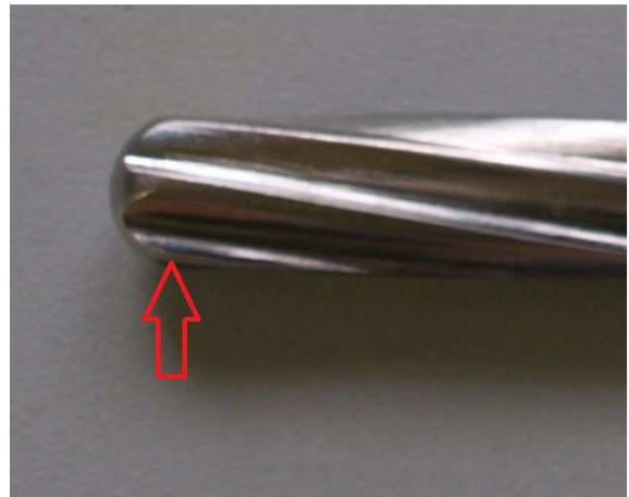
Obr. 81 Fréza č. 1 detail koroze šipka značí místo defektu
