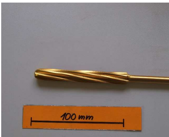
Obr. 88 Fréza č.5 celkový pohled koroze
