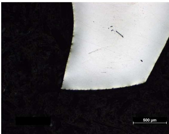
Obr. 40 Celkový pohled opotřebení ostří vzorek B
