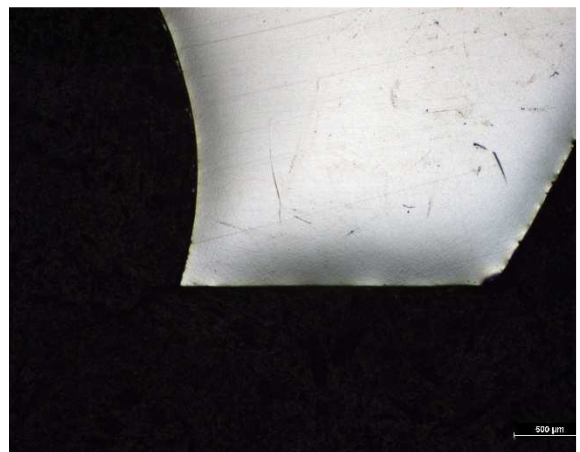
Obr. 41 Celkový pohled opotřebení ostří vzorek A
