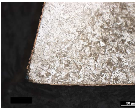
Obr. 60 Celkový pohled na povlak ostří nástroje v nenamáhané řezné části nástroje vzorek B
