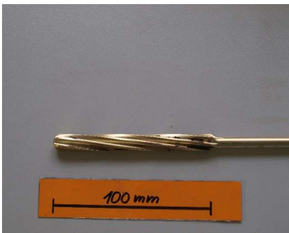
Obr. 84 Fréza č.3 celkový pohled koroze
