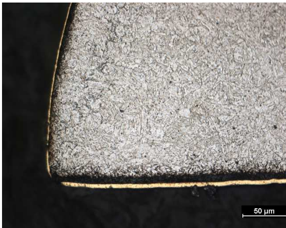
Obr. 64 Celkový pohled na povlak ostří nástroje v nenamáhané řezné části nástroje vzorek B
