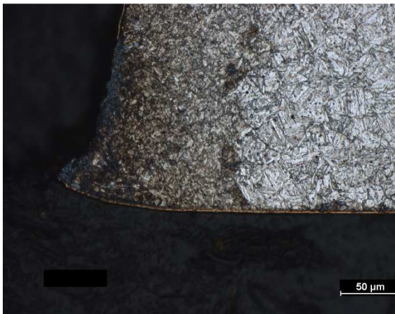
Obr. 72 Celkový pohled na povlak ostří nástroje v nenamáhané řezné části nástroje vzorek B
