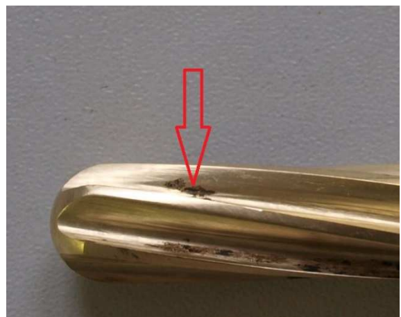
Obr. 85 Fréza č. 3 detail koroze šipka značí místo defektu
