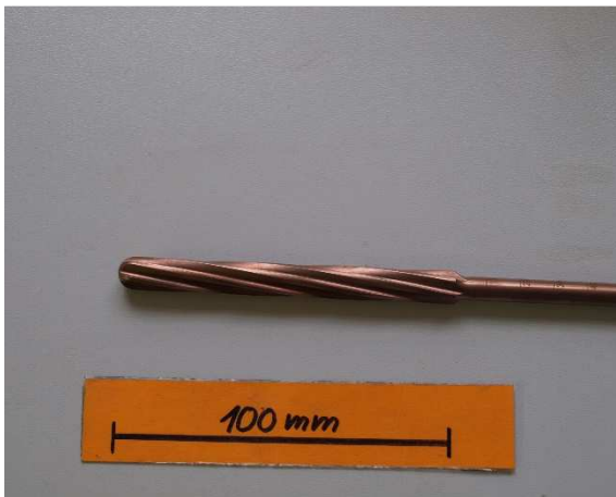
Obr. 82 Fréza č.2 celkový pohled koroze
