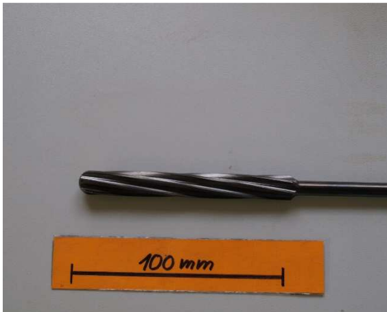
Obr. 86 Fréza č.4 celkový pohled koroze
