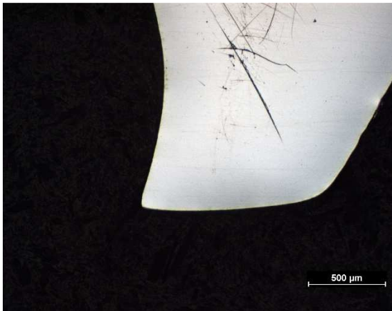
Obr. 32 Celkový pohled opotřebení ostří vzorek B
