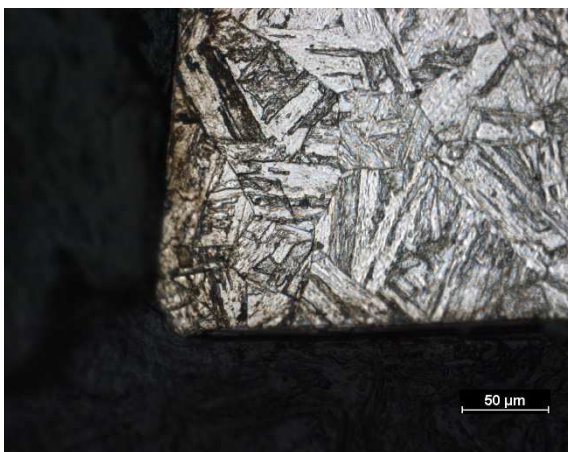
Obr. 56 Celkový pohled na povlak v oblasti ostří nástroje vzorek A
