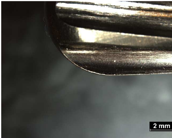
Obr. 36 Celkový pohled na opotřebení ostří
