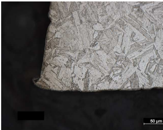
Obr. 68 Celkový pohled na povlak ostří nástroje v nenamáhané řezné části nástroje vzorek B
