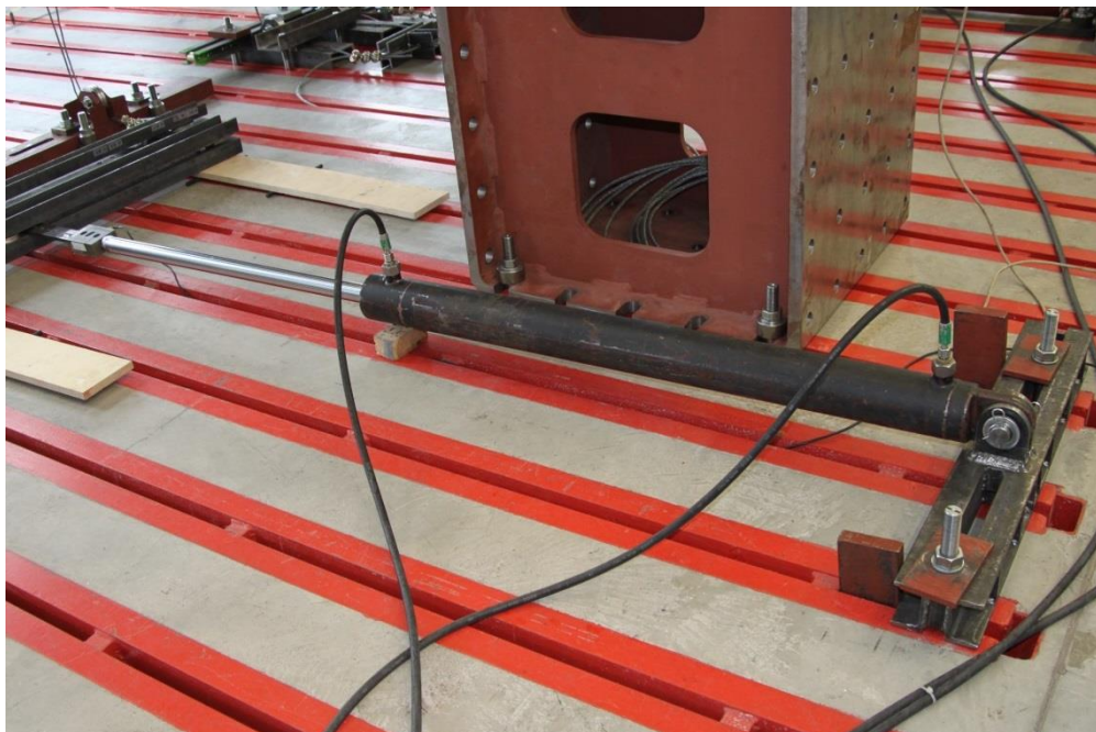
Obr. 2 – Zatěžovací hydraulický válec
