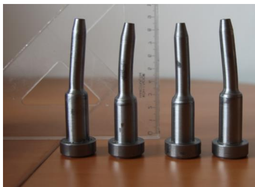
Obr. 17 – čepy po zkoušce
