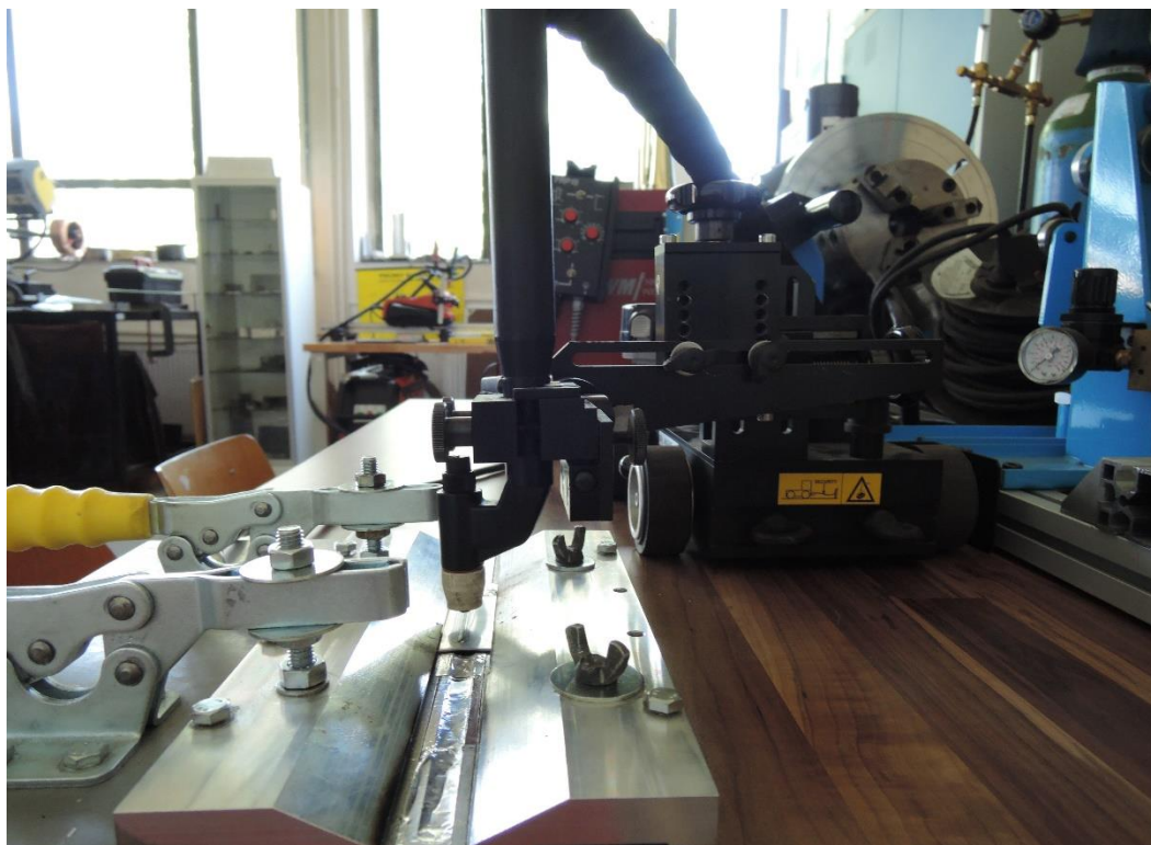
Obr. 4.5 Poloha hořáku při svařování
