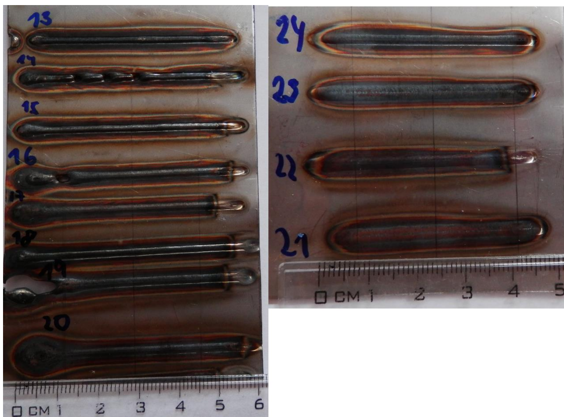
Obr. 4.7 Svarové (návarové) housenky
