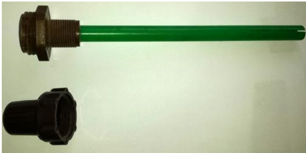
Obr. 19: Ochrana proti ztrátě písku
