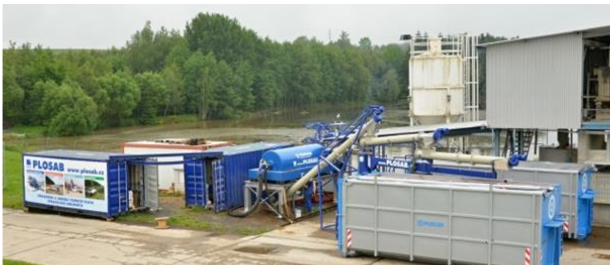
Obr. 30: Mobilní odvodňovací linka s odstředivkou
