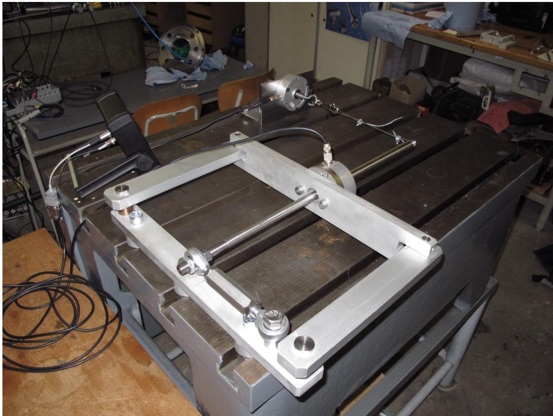
Obrázek 38 Měření siloměru S-35
