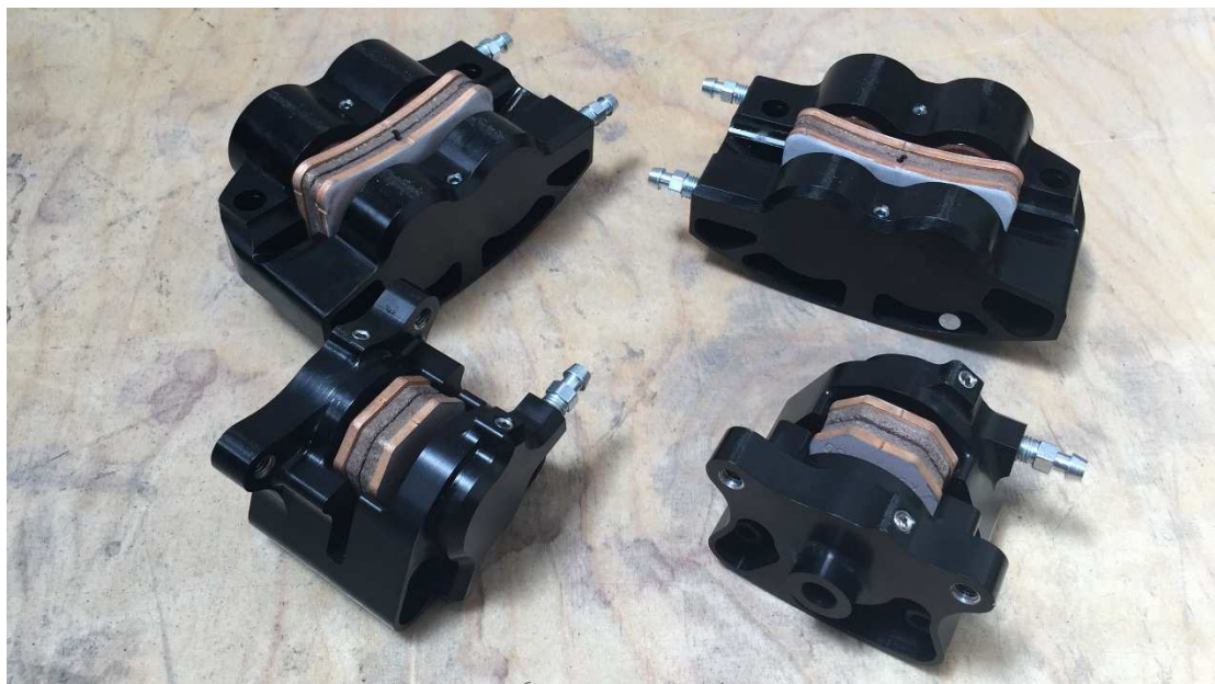
Obr. 28: Smontované brzdíče - pohled zespodu Zdroj: autor
