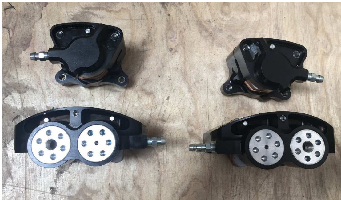
Obr. 27: Smontované brzdíče - pohled z boku Zdroj: autor
