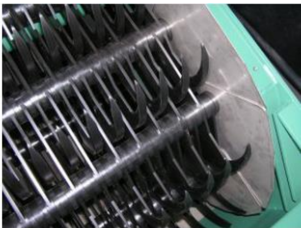
obr. 1. 4.: Samočistící česle hrubé – vlevo; samočistící česle jemné – vpravo [4]
