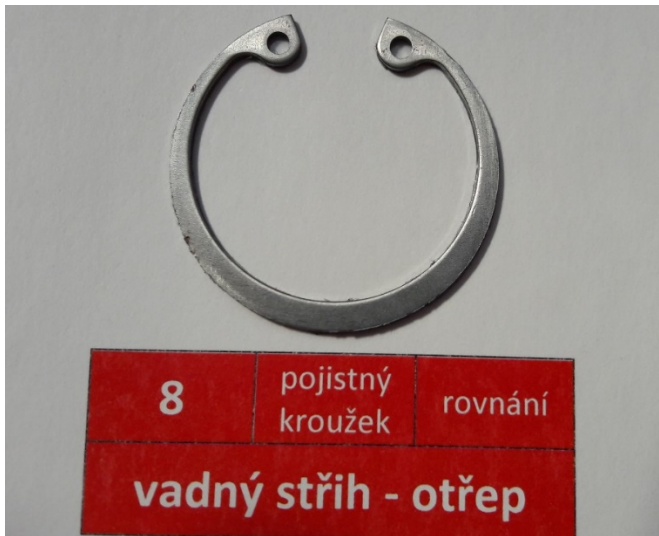
[Obr.19] Pojistný kroužek s otřepy
