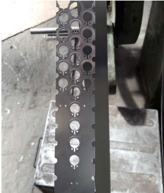
[Obr.16] Postupové lisování z pásky
