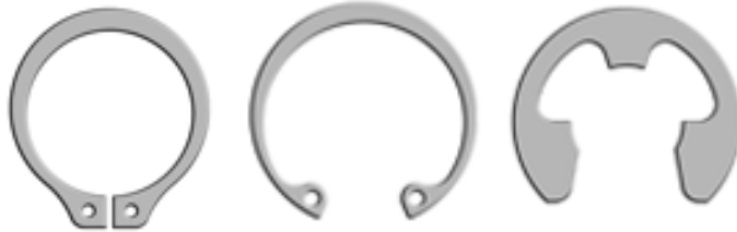
[Obr.3] Typy pojistných kroužků, zleva: PK pro hřídele, PK pro díry, třmenové PK[4].
