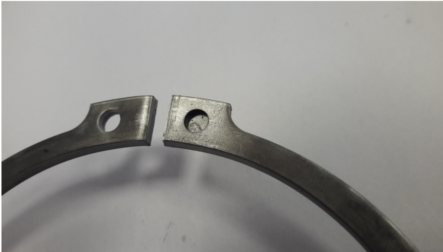
Obr. [26] Nevystřižené montážní otvory z důvodu ulomení děrovače
