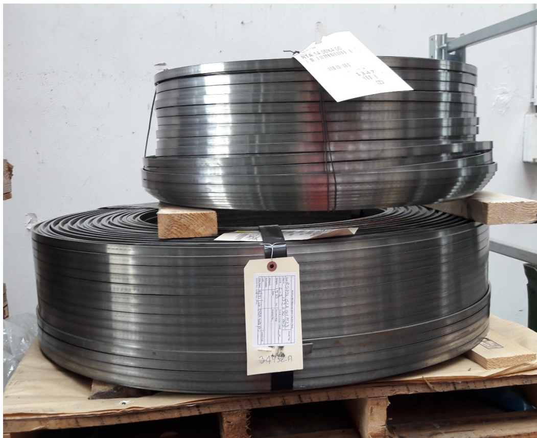
[Obr.18] Ocelové lichoběžníkové dráty dodávané ve svitcích
