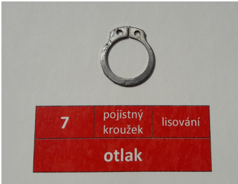
[Obr.20] Pojistný kroužek s otlaky
