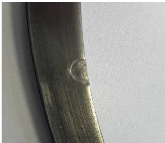
Obr. [27] Část pojistného kroužku s viditelným otlakem
