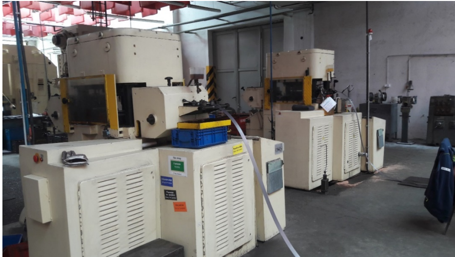
Obr. [12] Lisy typu PASSU pro postupové lisování
