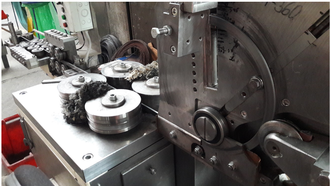
Obr. [10] Stáčecí stroj vlastní konstrukce a výroby
