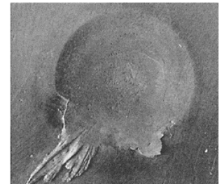
Obrázek 12 Výstřik svařovaného kovu [5]
