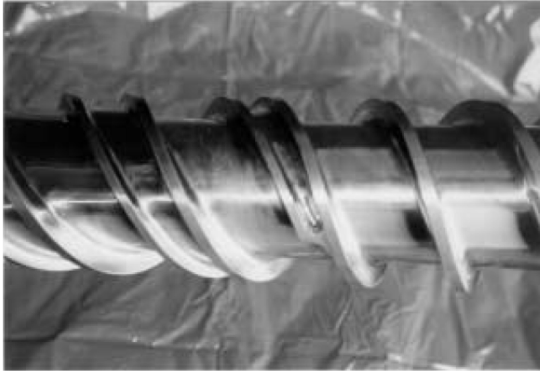
Obr. 11 předěl mezi feeding a melting zone – různé stoupání. V místě změny jsou dva závity [3]
