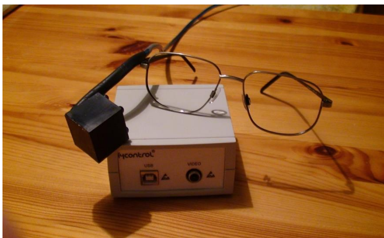
Obr. 6.2 – Oční kamera – obruba brýlí
