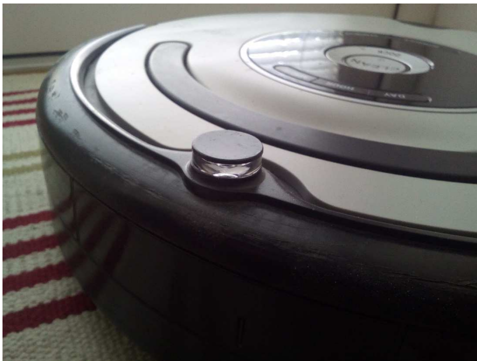
Obrázek 14: Snímač signálů z dokovací stanice na robotickém vysavači iRobot Roomba 563 Pet
