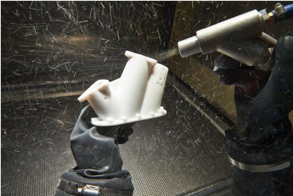
Obrázek 18 - Tryskání tištěné součásti broky [12]
