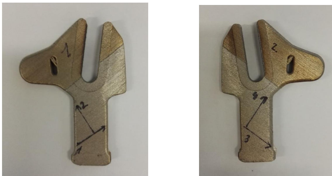
Obrázek 34 – Směry měření drsnosti
