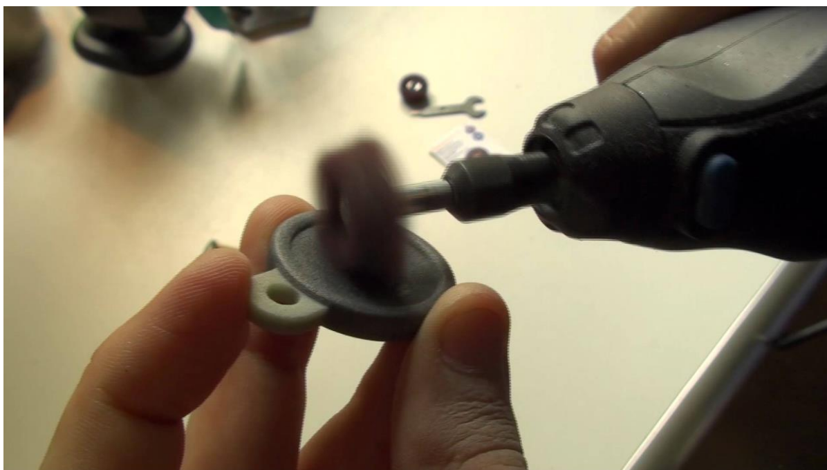
Obrázek 16 - Broušení po 3D tisku [12]
