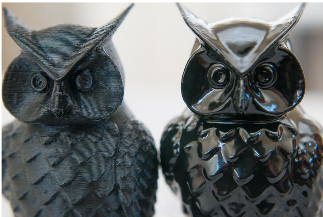
Obrázek 24 - Výrobek před (vlevo) a po parním vyhlazováním (vpravo)[14]
