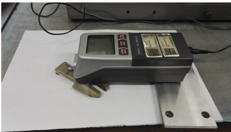
Obrázek 33 – Měřicí přístroj Mitutoyo sj201p
