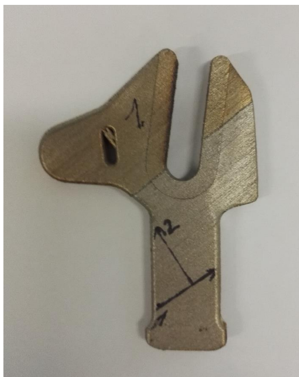
Obrázek 32 - Vzorek po odstranění podpěr
