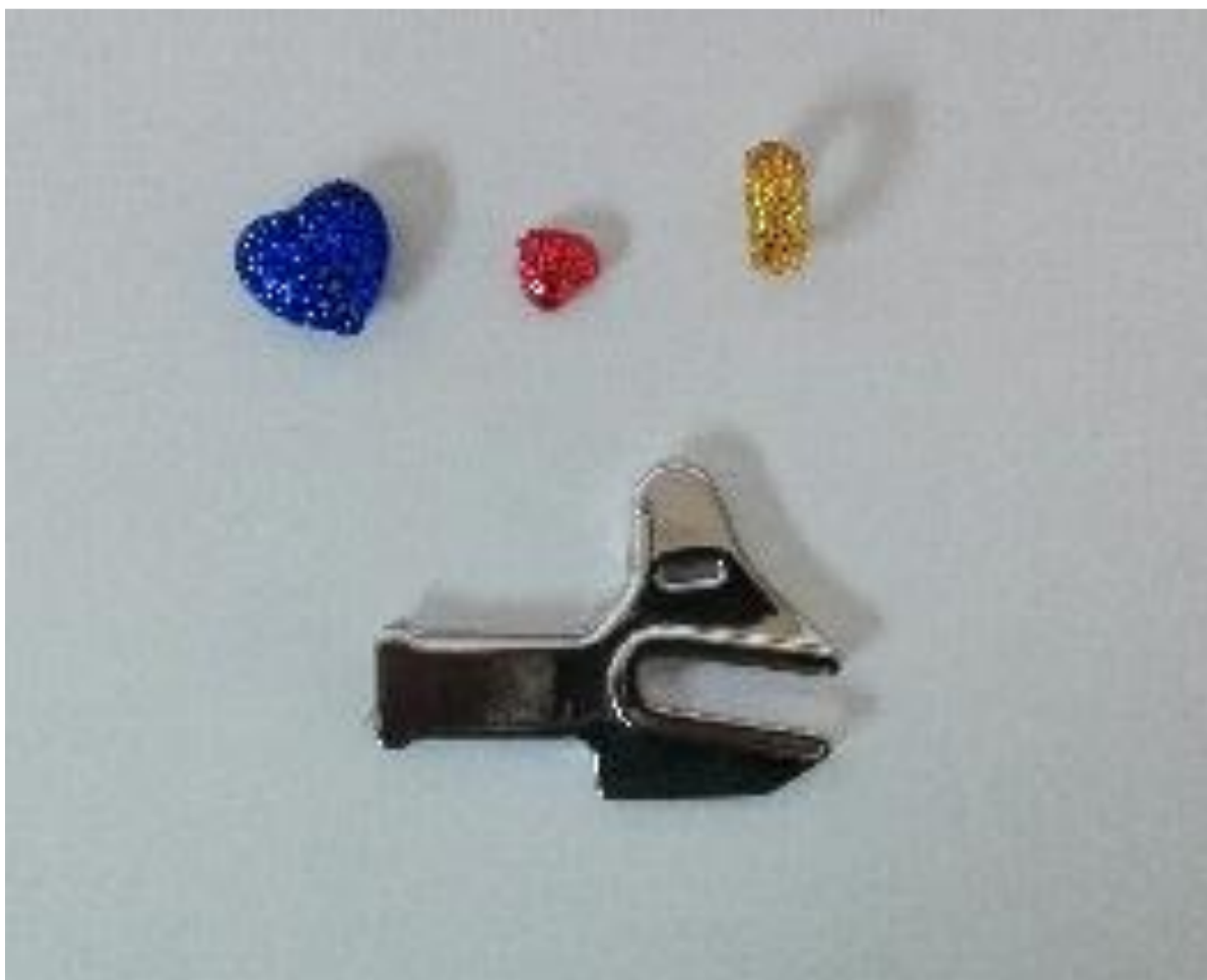
Obrázek 48 - Vzorky po aplikaci stříkaného chromu
