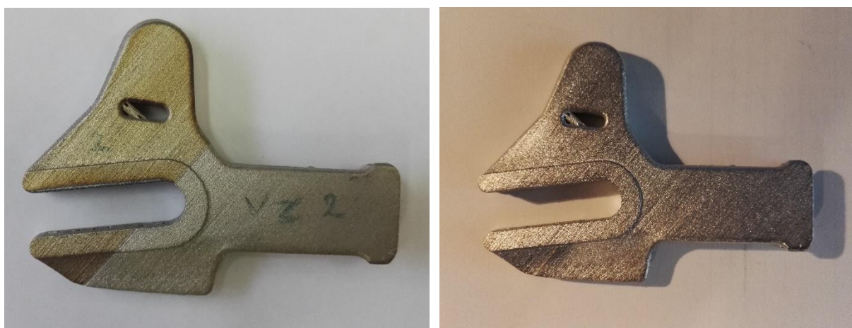
Obrázek 45 - Východí vzorek č.2 (vlevo) a vzorek po tryskání a elektrolytickém leštění (vpravo)
