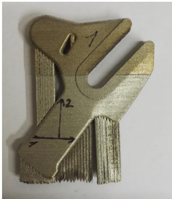
Obrázek 31 - Vzorek s technologickými podpěrami
