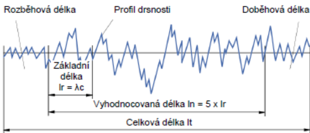
Obrázek 11 - Základní a vyhodnocovaná délka, délka rozběhu a doběhu
