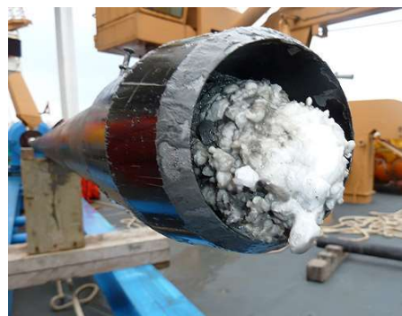
Obrázek 12 Plynový hydrát v potrubí [10]
