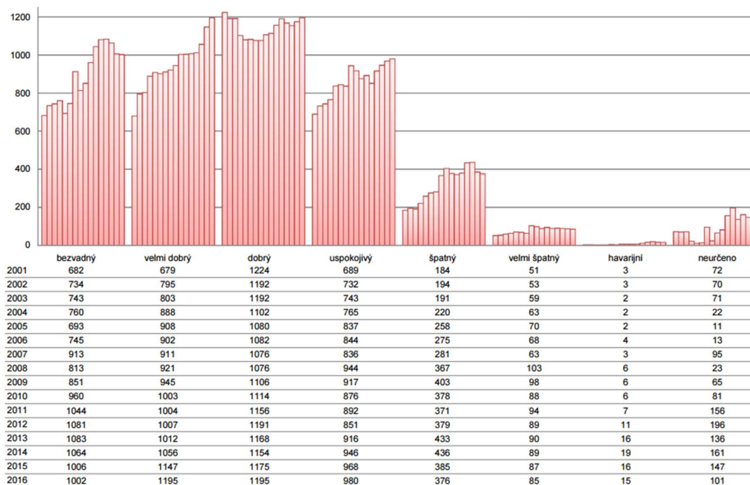
Obr. 3.6 Mosty dle stavu nosné konstrukce nebo spodní stavby (bere se u úvahu horší stav) na dálnicích a silnicích I. Třídy v letech 2001-2016, data k 1.1.2016 Zdroj: [7]
