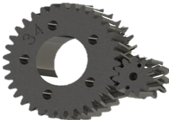
obr. 29 – model převodu ozubenými koly s šípovým ozubením
