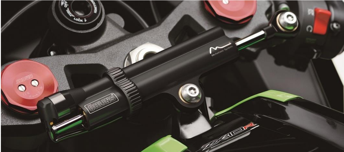
Obr. 14 Tlumení řízení motocyklu Zdroj: www.motohouse.cz
