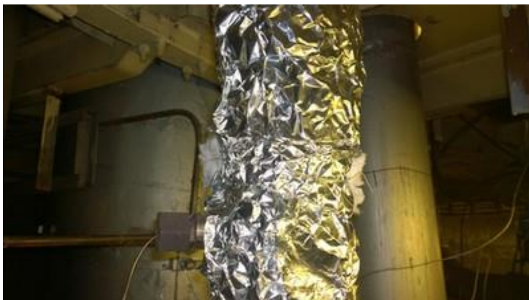
Obrázek 13: Zaizolované potrubí s termočlánky
