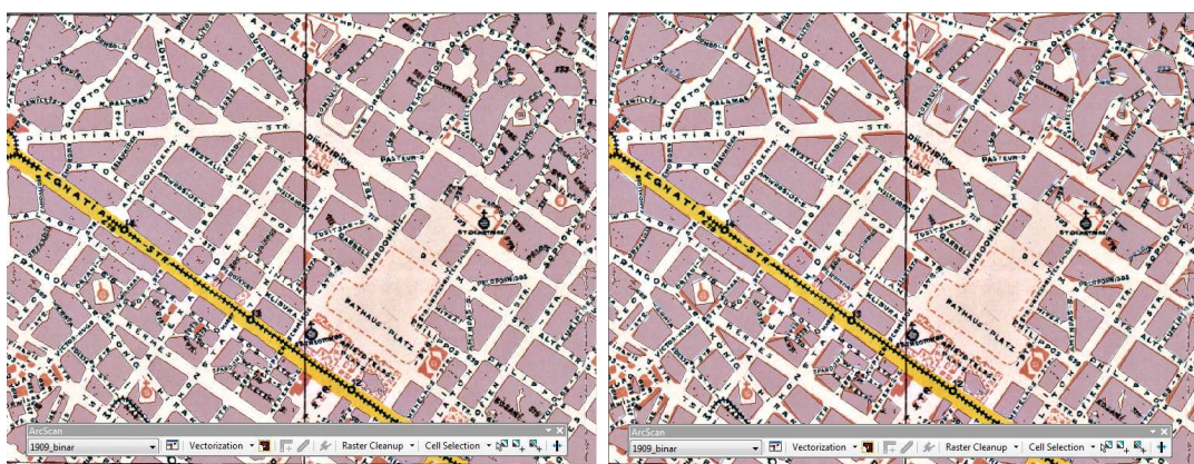
Obrázek 4.14: Detail polygonové vrstvy budov před generalizací (vlevo) a po generalizaci (vpravo)
