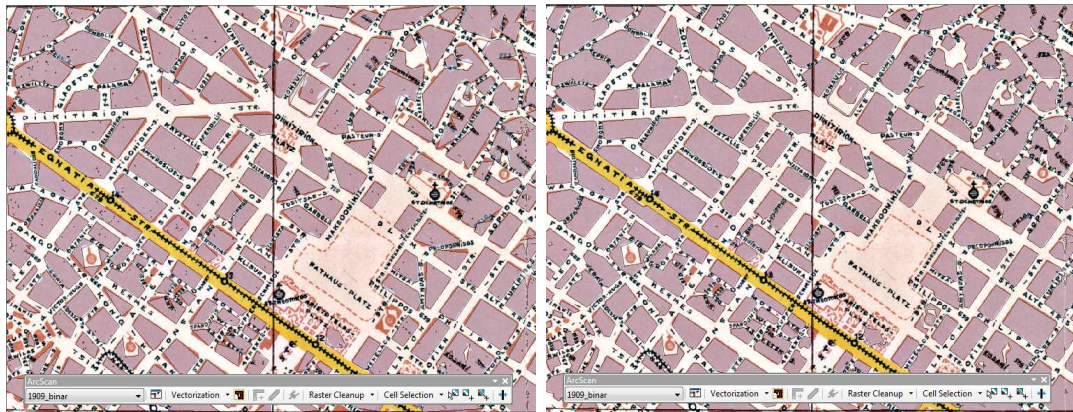
Obrázek 4.15: Porovnání detailu polygonové vrstvy budov vzniklé pomocí funkce Feature to polygon (vlevo) a pomocí nástroje ArcScan
