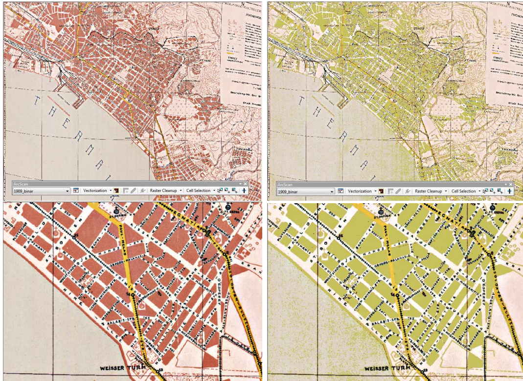
Obrázek 4.10: Německá mapa (vlevo) a binární rastr (vpravo žlutě) vzniklý reklasifikací, dole detaily téhož
