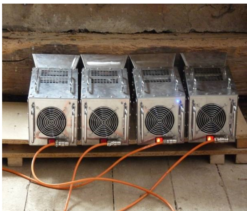
Obr.42- Ozařování vazného trámu napadeného tesaříkem krovovým (zdroj: www.tzb-info.cz )
