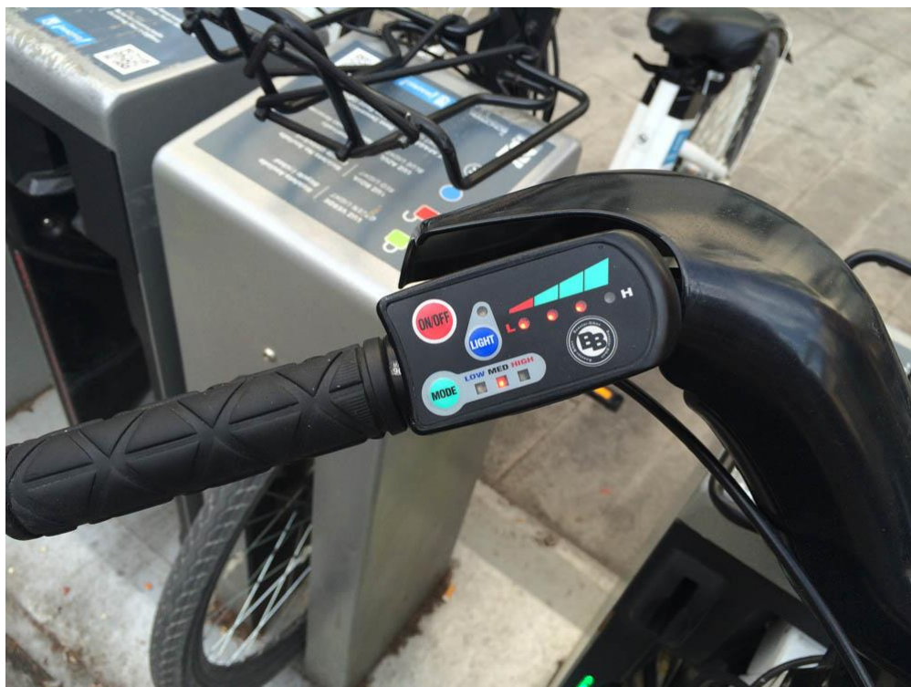
Obrázek 12: Ovládání asistence motoru [33]
