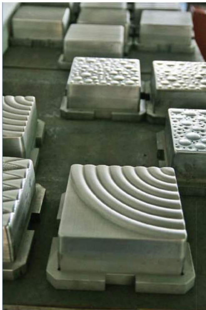
Forma na výrobu skleněných tvárníc
