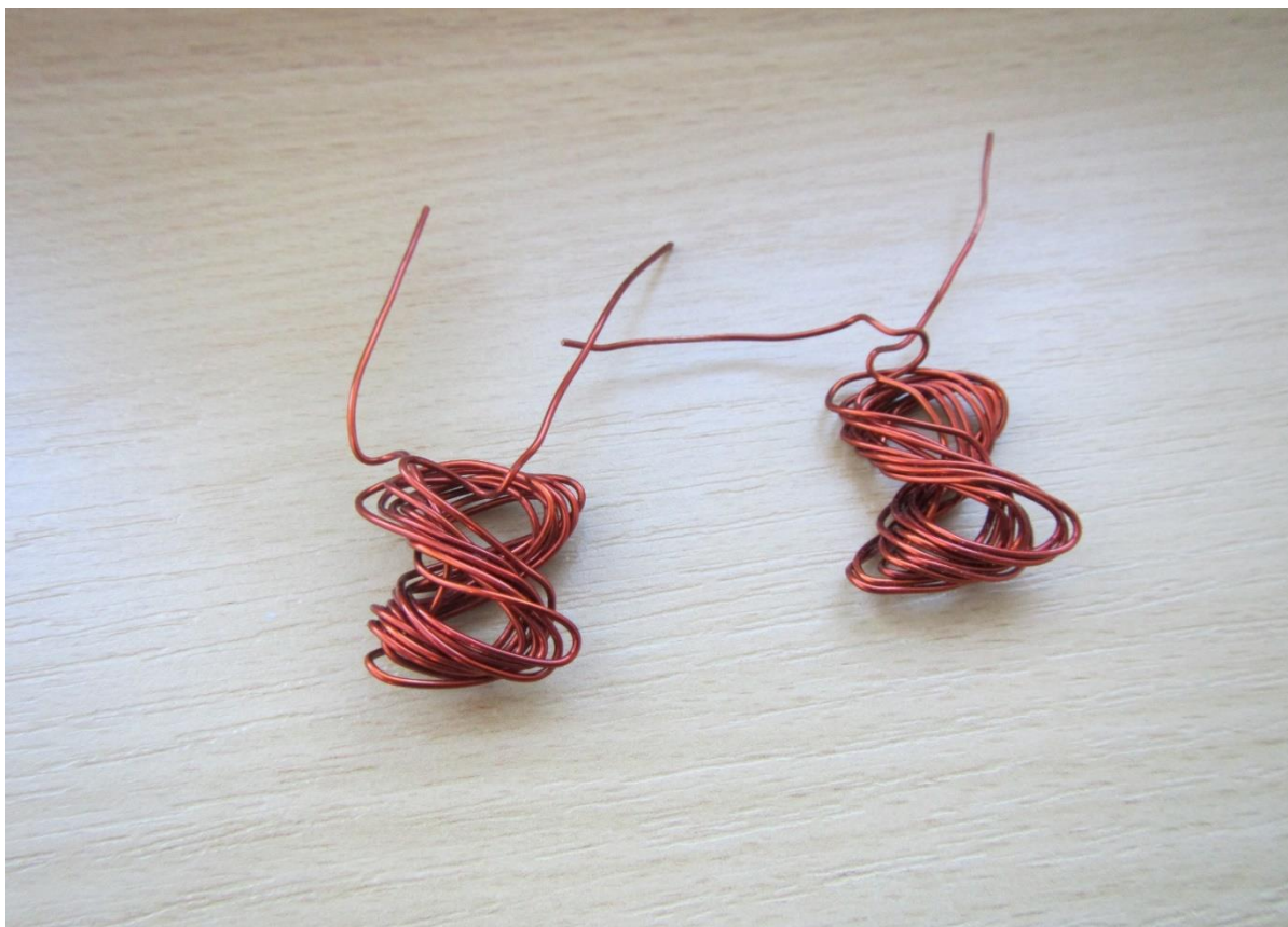
Obrázek 16 - Překroucené funkční cívky
