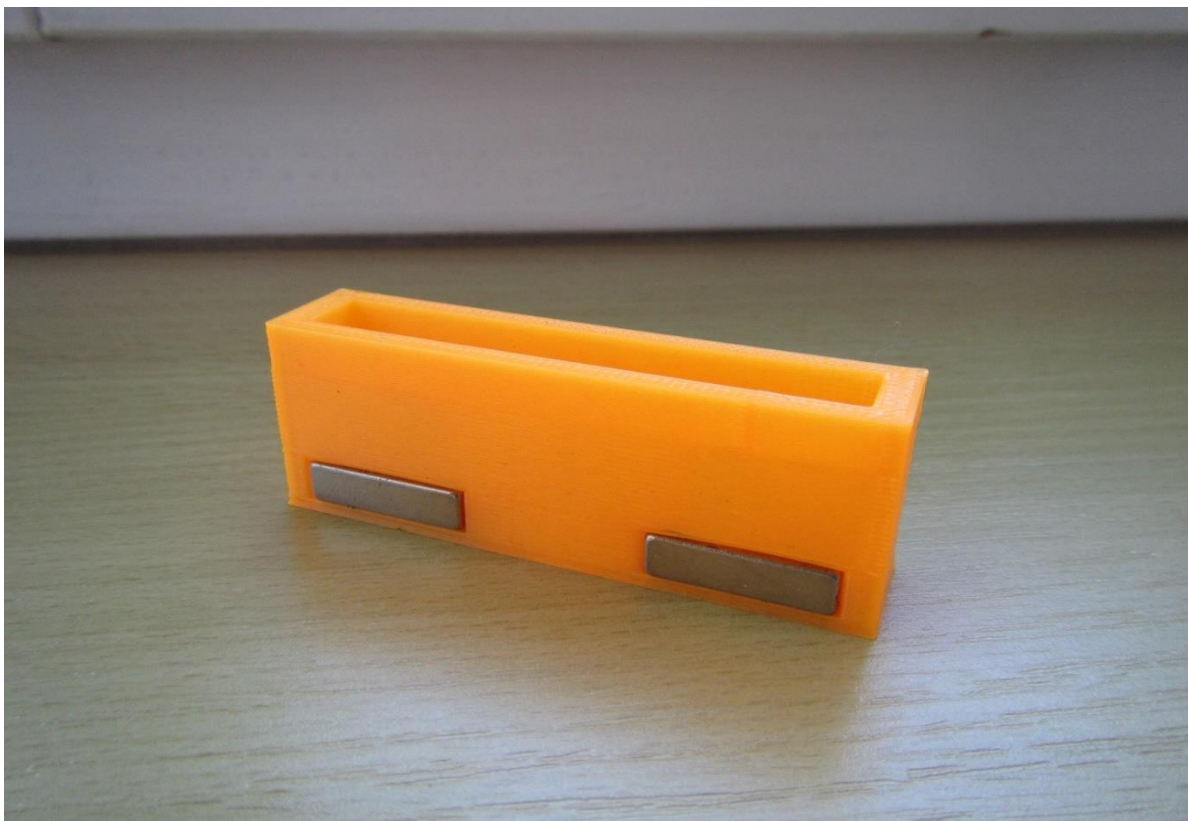
Obrázek 21 - Delší vagónek se 4 magnety
