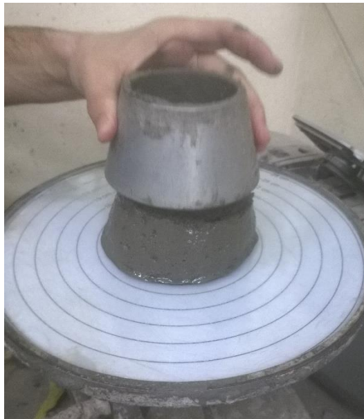
Obr. 66: Zkouška rozlití – sejmutí kužele [29]
