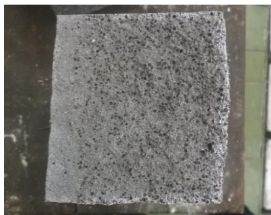
Obr. 93: Rozlomený trámec T1, spodní povrch bez lehkého kameniva [29]
