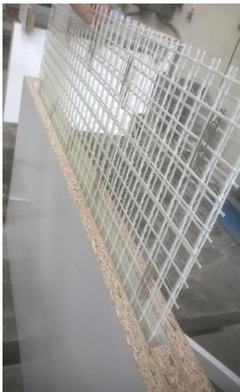
Obr. 62: Osazení distančníků v rastru [29]
