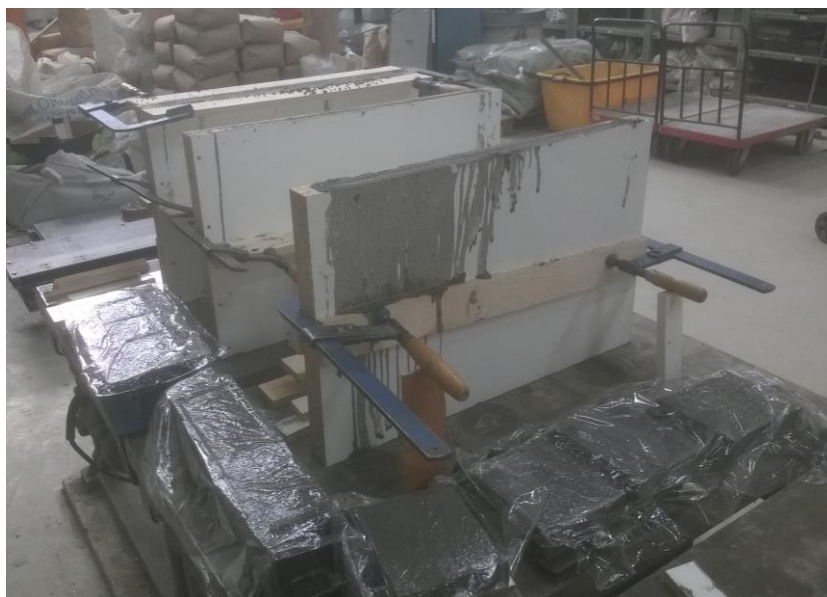
Obr. 71: Desky vertikálně betonované, zajištěny svěrkami [29]
