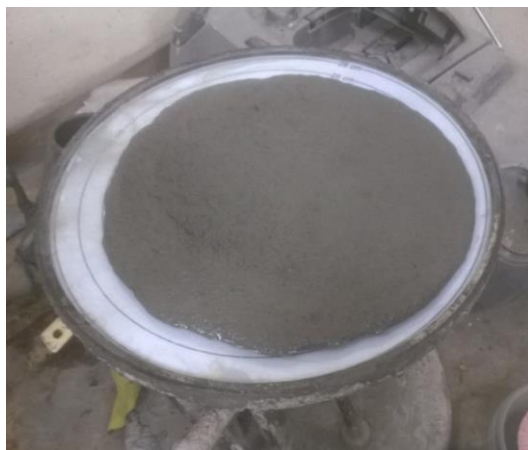
Obr. 67: Zkouška rozlití – rozlití během pár vteřin [29]
