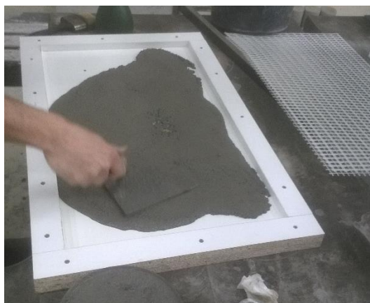
Obr. 68: Tvoření krycí vrstvy - vodorovná betonáž [29]
