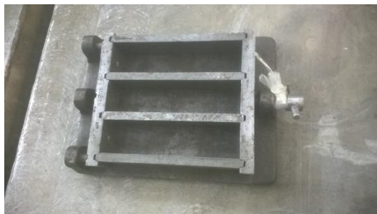
Obr. 60: Forma trámečků 40 x 40 x 150 mm [29]
