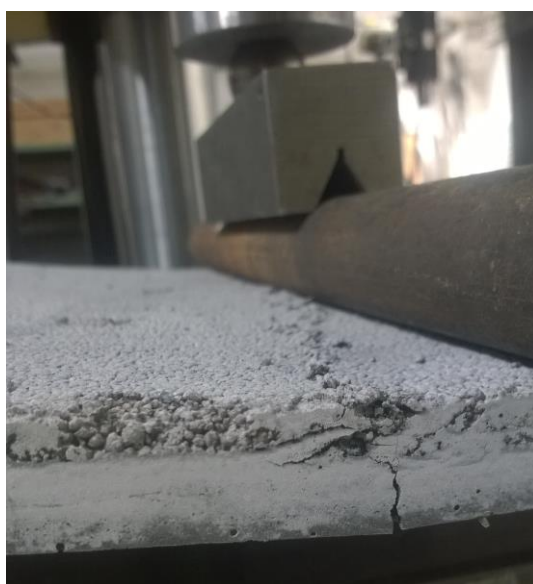
Obr. 87: Drcení betonu deska D2 [29]
