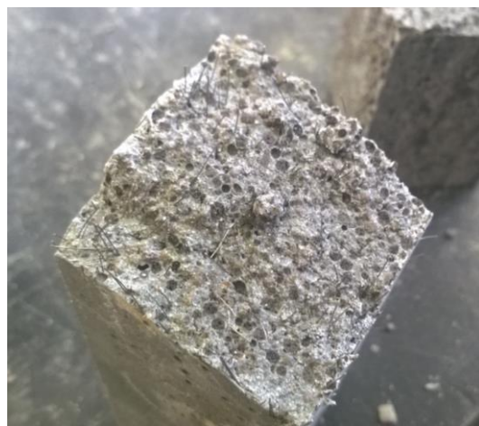
Obr. 97: Rovnoměrné rozptýlení lehkého kameniva v směsi [29]
