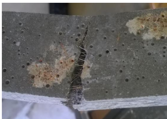
Obr. 96: Porušený prvek třibodovým ohybem [29]
