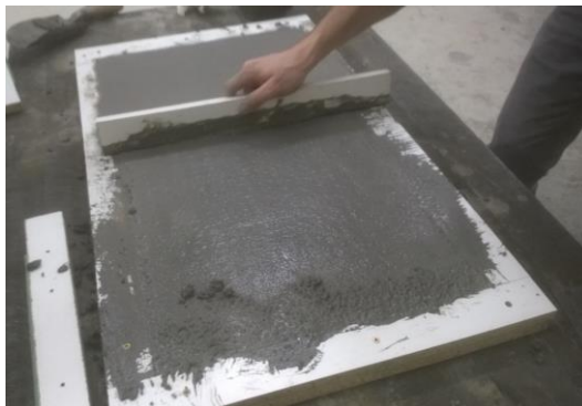
Obr. 70: Uhlazení povrchu – vodorovná betonáž [29]
