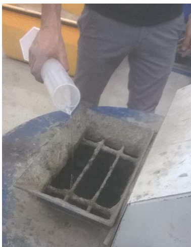
Obr. 65: Přidávání plastifikátoru do míchačky [29]
