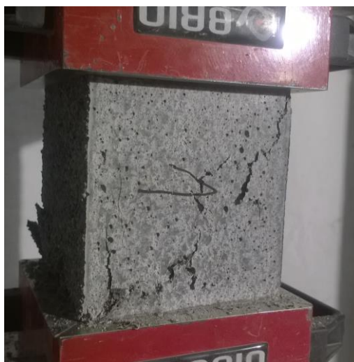
Obr. 99: Tlakové porušení vzorku [29]
