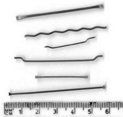
Obr. 20: Drátky do drátkobetonu [21]
