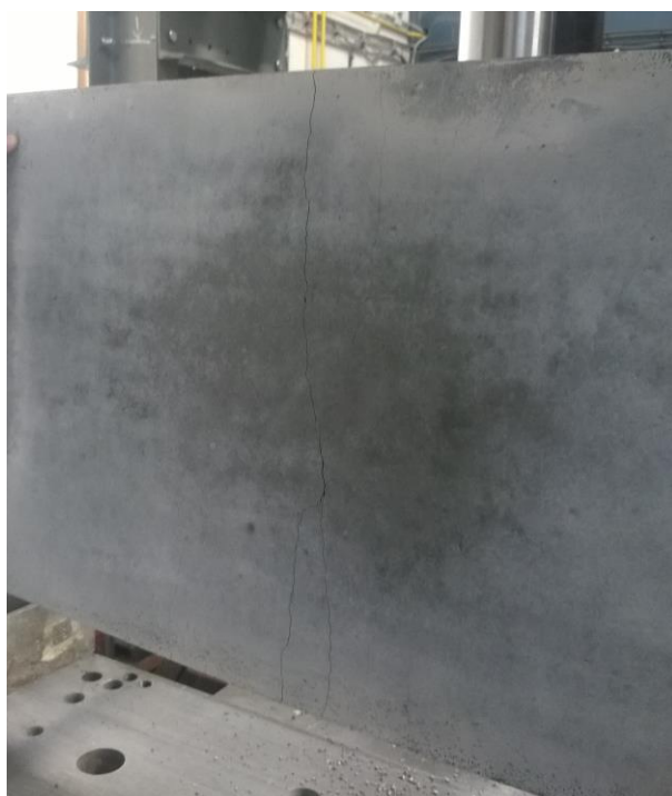
Obr. 88: Po odtížení desky D2, spodní líc [29]
