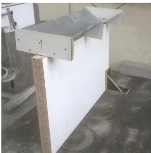
Obr. 58: Vertikální bednění s nástavcem [29]
