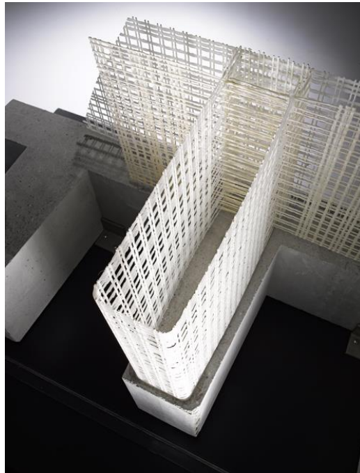
Obr. 51: Výztužné síť v průřezu nosníku [57]
