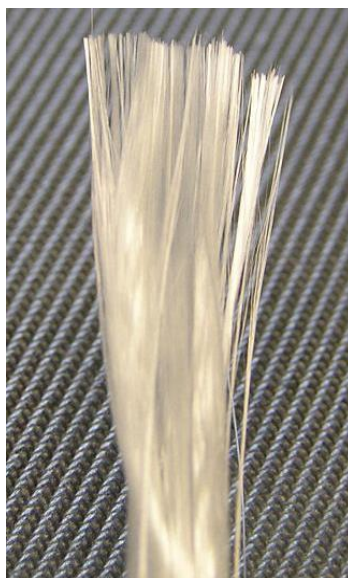
Obr. 42: Svazek skleněných filamentů (UD-Roving,) [45]
