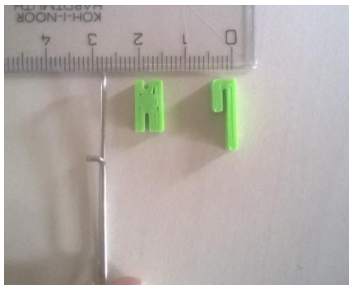
Obr. 61: Distančníky z 3D tiskárny - Levý 3 mm, pravý 2 mm a kancelářská sponka 3mm [29]
