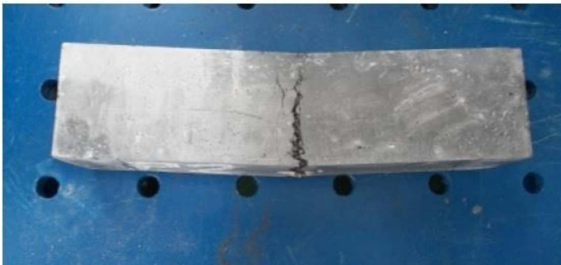
Obrázek 30: Vzorek po dopadu rázového kyvadla z výšky 0,7m. [5]
