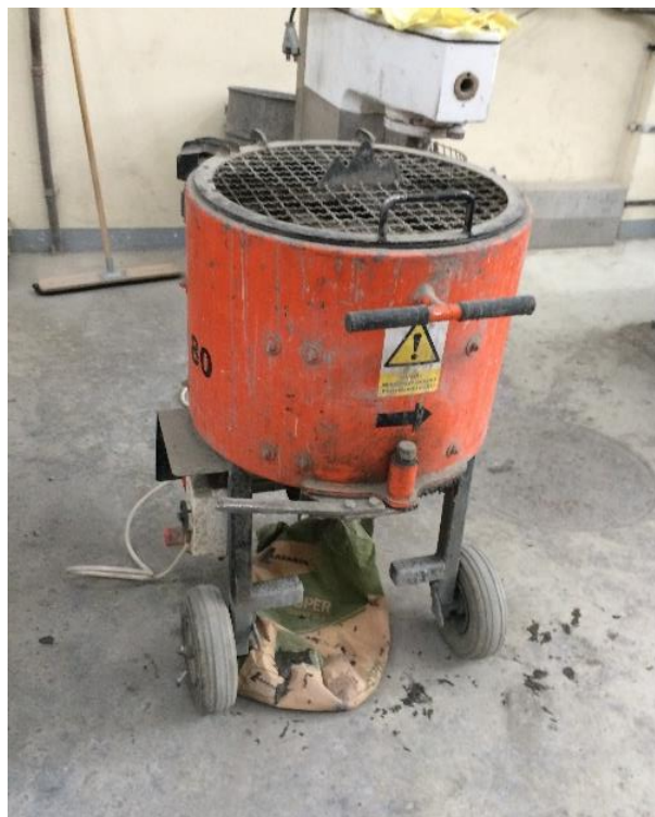
Obrázek 8: Talířová míchačka o objemu 40 l.
