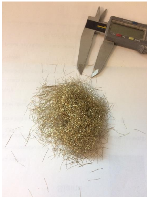
Obrázek 9: Vysokopevnostní mikrovlákná z ocele použítá ve směsi UHPFRC.
