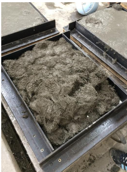
Obrázek 12: Betonová směs se 4,7 % zastoupením ocelových vláken, po vlití do formy.
