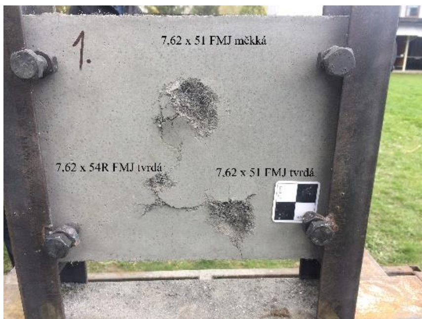
Obrázek 20: Zadní strana testované desky s obsahem vláken 4,7 % ocelových vláken.
