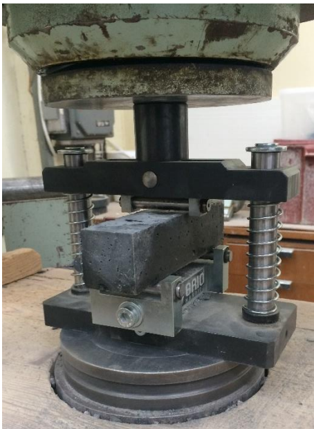
Obrázek 24: vlevo: zatížení trámku třibodovým lisem, vpravo: porušení trámku třibodovým lisem.
