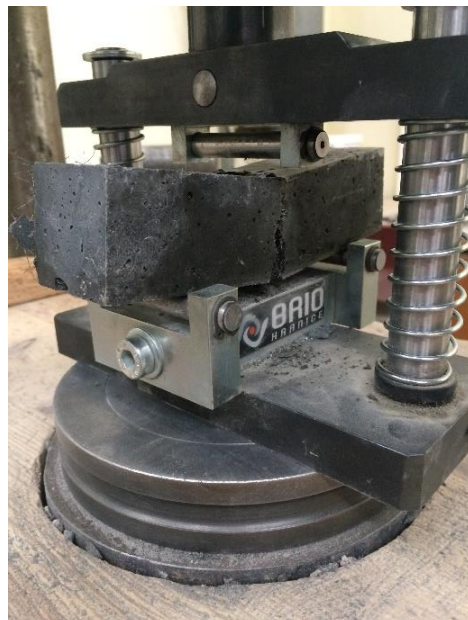
Obrázek 24: vlevo: zatížení trámku třibodovým lisem, vpravo: porušení trámku třibodovým lisem.
